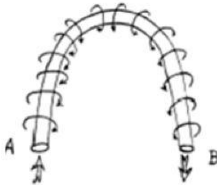
Gambar 2. 12 Medan magnet mengelilingi konduktor di antara kutub
