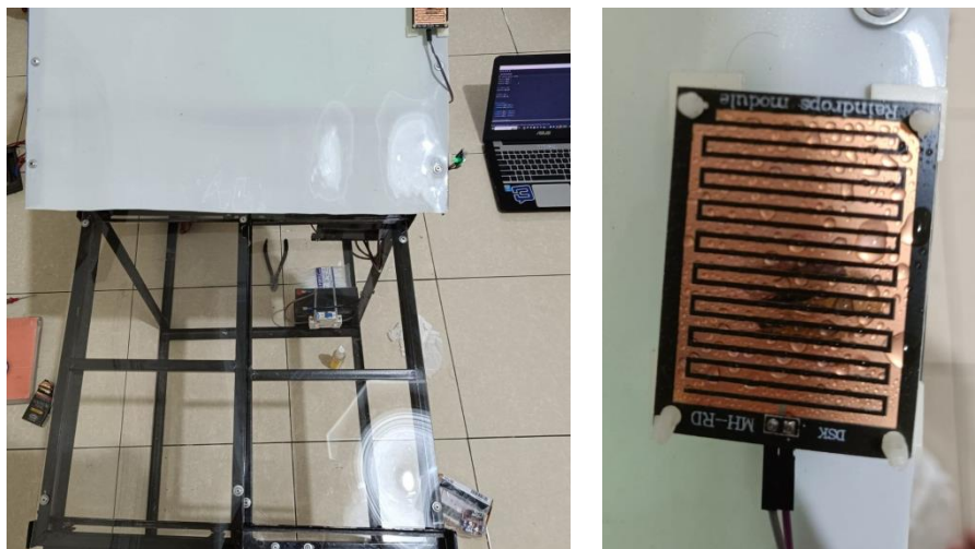
Gambar 4. 17 Kondisi Sensor Hujan Terkena Air
