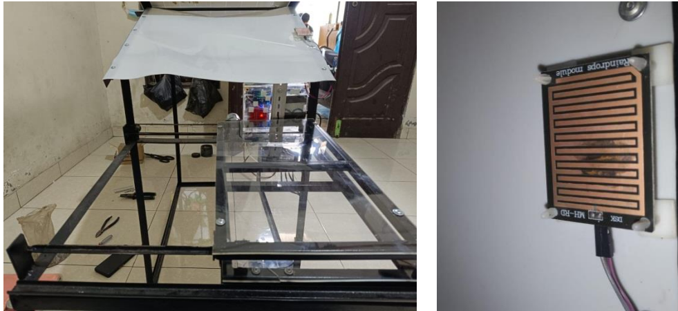
Gambar 4. 18 Kondisi Sensor Hujan Tidak Terkena Air
