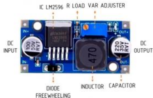
Gambar 2. 18 Bagian bagian dan Step-Down LM2596
