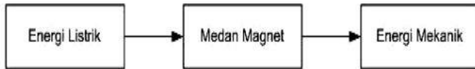
Gambar 2. 10 Proses Konversi Energi Pada Motor DC
