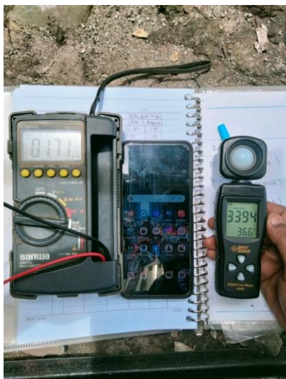
Gambar 4.3 Intensitas Cahaya, V dan I Panel Surya dengan Beban
