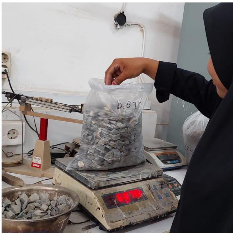
Gambar Lampiran 10: Penimbangan agregat kasar sesuai dengan kebutuhan benda uji.
