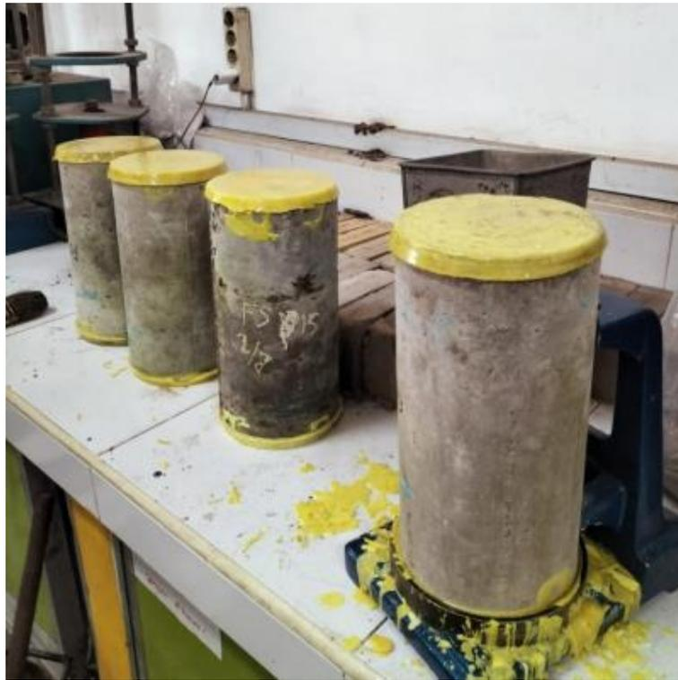
Gambar Lampiran 19: Pemasangan *capping* pada benda uji.
