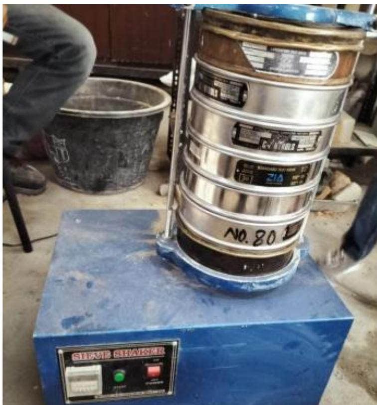
Gambar Lampiran 4: Pengujian analisa saringan.
