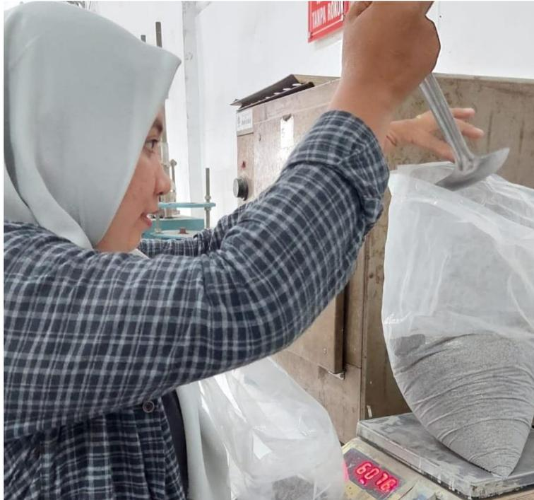
Gambar Lampiran 9: Penimbangan agregat halus sesuai dengan kebutuhan benda uji.
