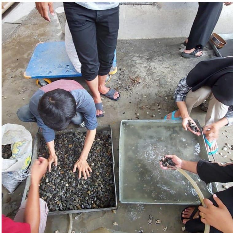
Gambar Lampiran 8: Pencucian agregat kasar dari lumpur dan kotoran.
