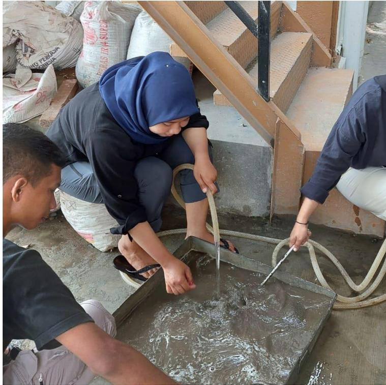
Gambar Lampiran 7: Pencucian agregat halus dari lumpur dan kotoran.
