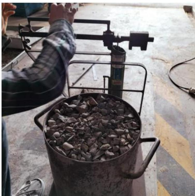
Gambar Lampiran 6: Pengujian berat isi agregat.
