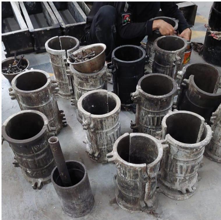
Gambar Lampiran 15: Persiapan cetakan silinder.
