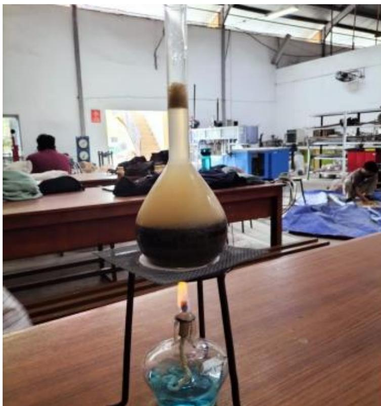
Gambar Lampiran 5: Pengujian berat jenis agregat.
