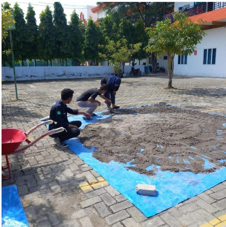
Gambar Lampiran 3: Penjemuran agregat hingga kondisi SSD.
