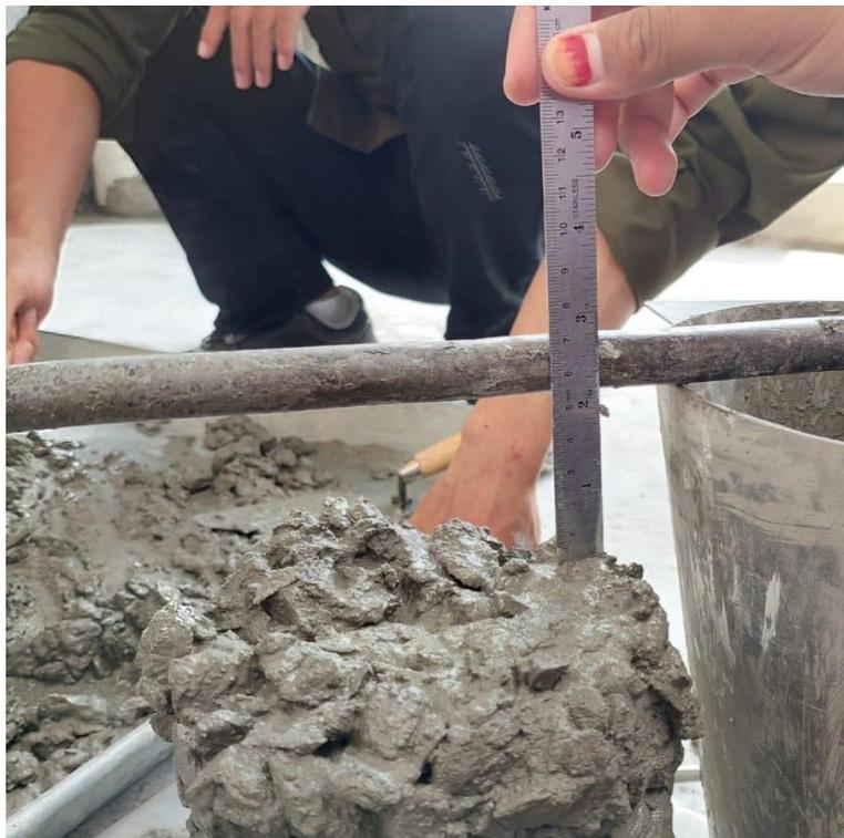
Gambar Lampiran 14: Pengujian *slump*.
