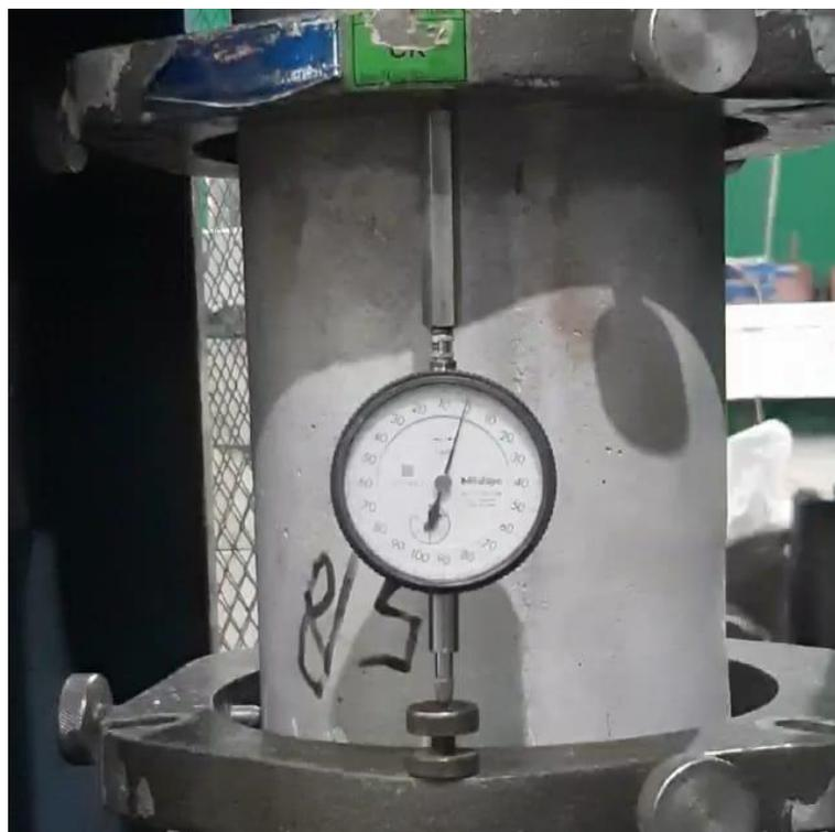
Gambar Lampiran 22: Pengujian modulus elastisitas.
