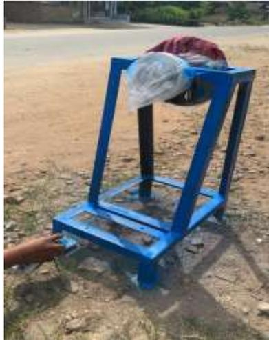
Gambar 4.13 Proses Pengecatan Rangka
