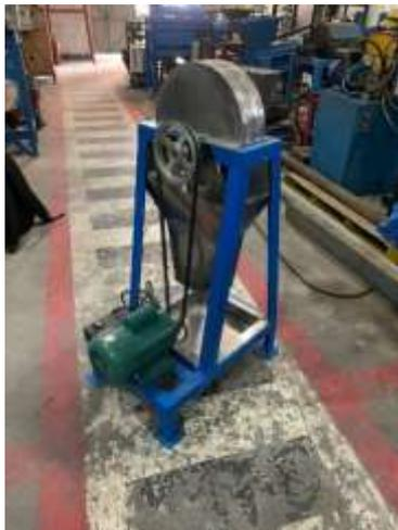
Gambar 4.18 Hasil Pembuatan Mesin Pengiris Bawang
