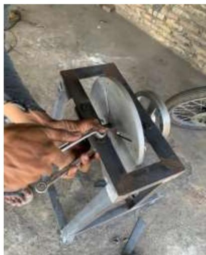
Gambar 4.12 Proses Pemasangan Bantalan
