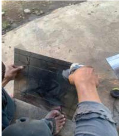
Gambar 4.11 Proses Pemotongan Plat Stainless
