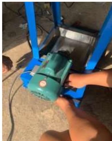
Gambar 4.14 Proses Pemasangan Motor Ke Rangka
