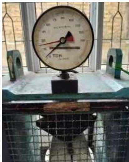
Lampiran 36: Proses Pengujian Kuat Tarik Belah Beton.
