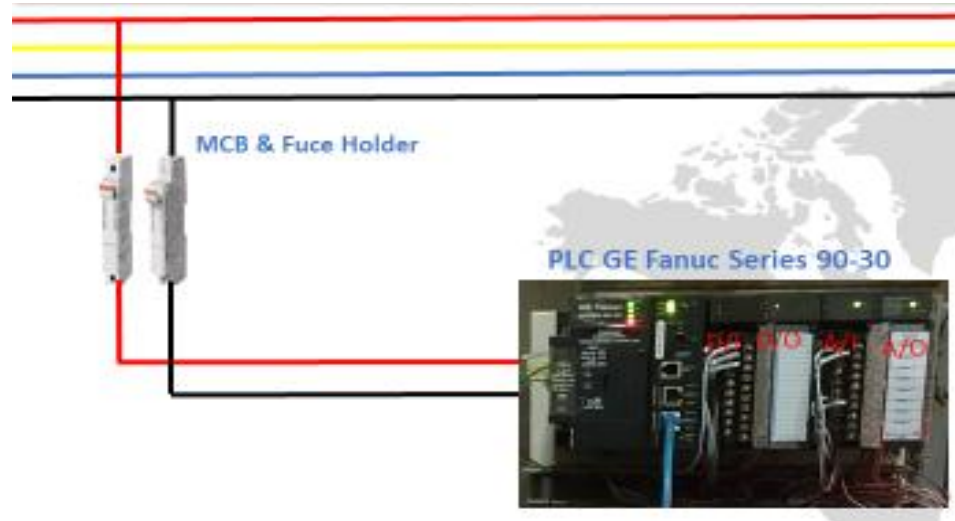
Gambar 3.2 Rangkaian Input Tegangan 220 VAC ke PLC
