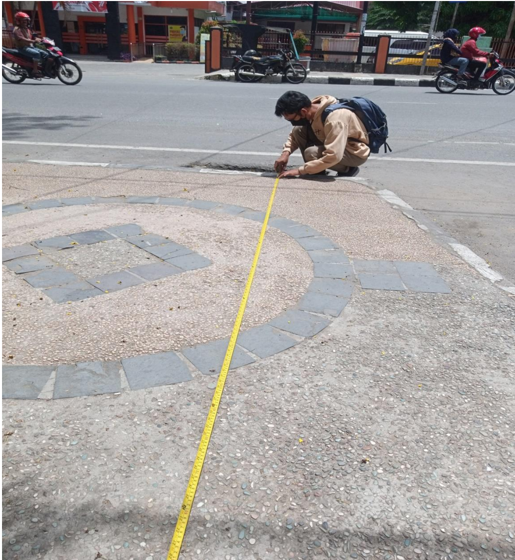
Gambar L2: Pengukuran lebar pedestrian pada jalan Dr. Sutomo, Kota Tebing Tinggi.
