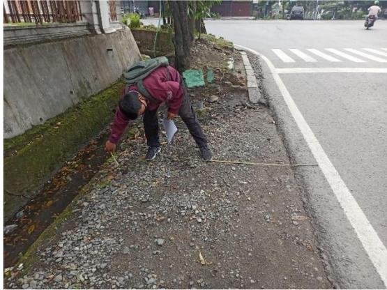
Gambar L.1: Mengukur Data Geometrik Jalan.
