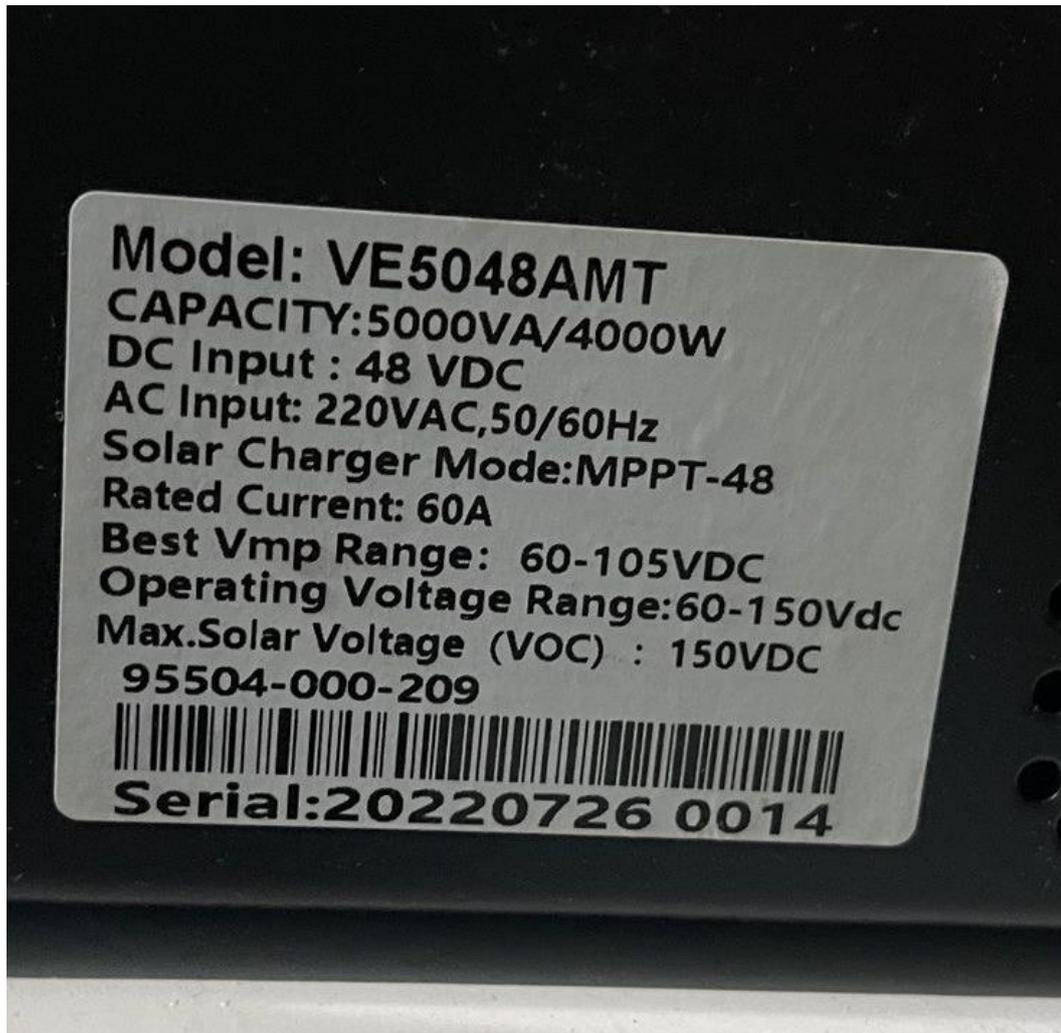
Gambar 7.6. Spesifikasi *Inverter* dan MPPT
