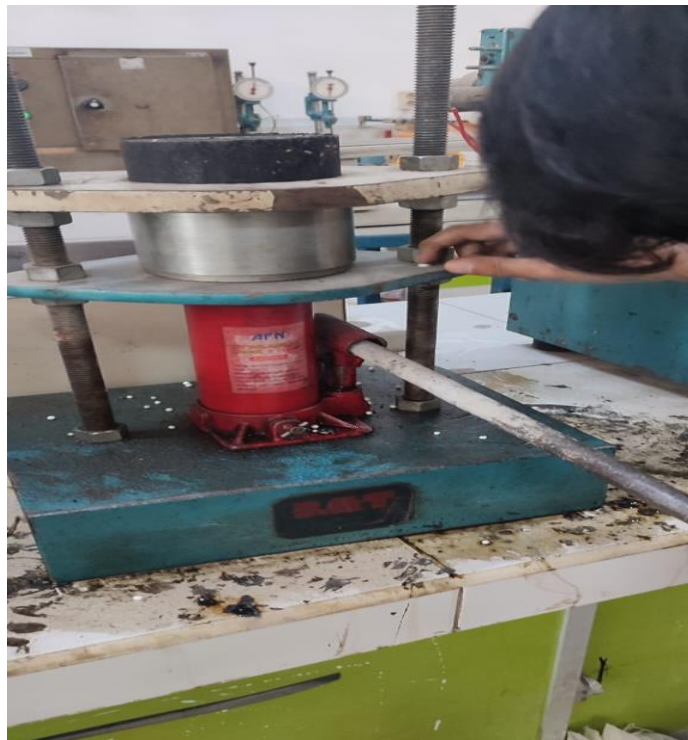
Gambar L.13 : Proses Pengeluaran Benda Uji Dari Cetakan
