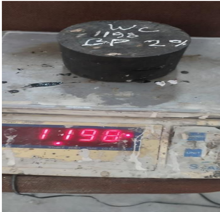
Gambar L.12 : Proses Penimbangan Benda Uji
