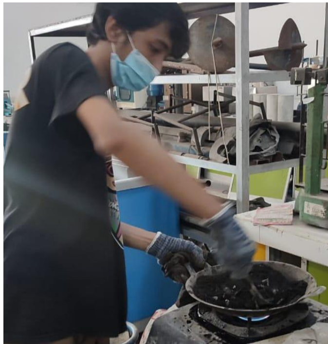
Gambar L.5 : Proses pencampuran aspal dan agregat
