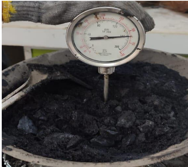
Gambar L.8 :Proses pengukurans suhu Aspal sebesar 160°C
