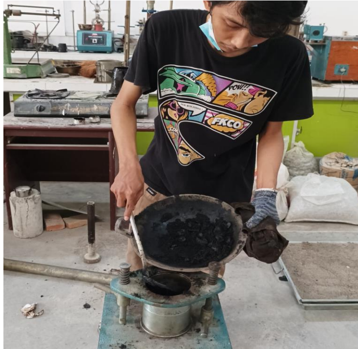
Gambar L.6 : Proses memasukkan campuran kedalam cetakan.
