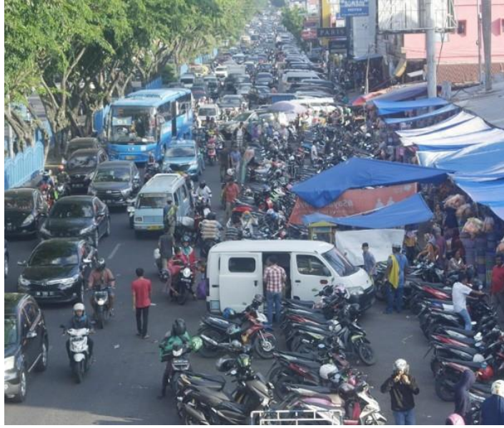
Gambar 2.5 : Hambatan Samping Sangat Tinggi
