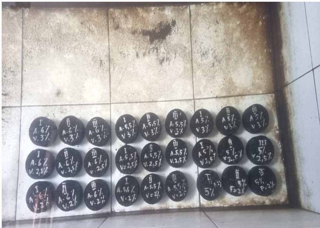
Gambar L17 : Proses Perendaman Benda Uji
