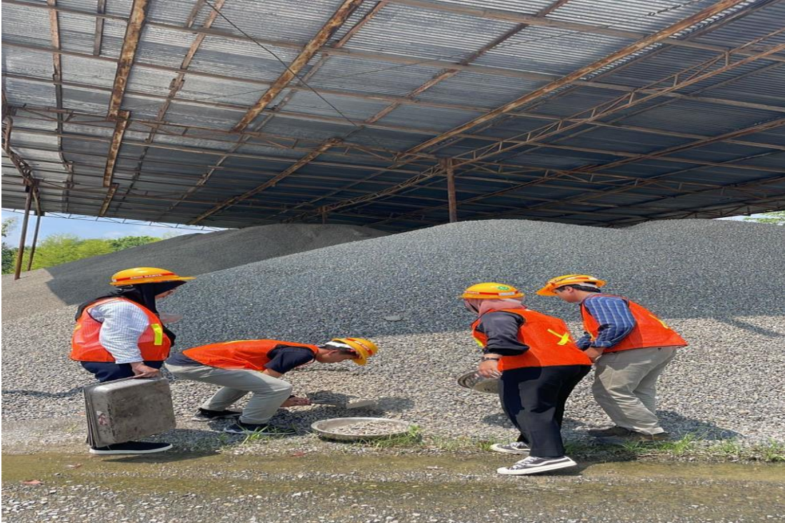
Gambar L12 : Pengambilan Agregat di PT. Adhi Karya
