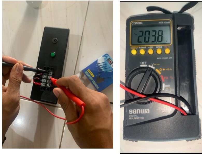
Gambar 4. 6. Pengukuran alat tanpa beban
