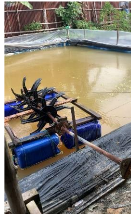
Gambar 3. 7. Kincir air dengan pelampung
