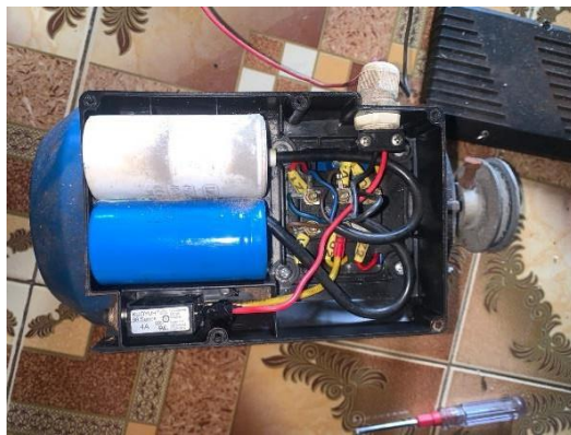
Gambar 3. 12. Motor sambungan bintang (Y)
