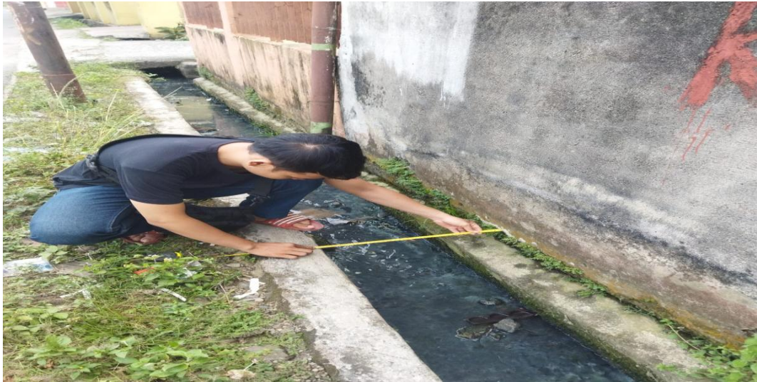
Pengukuran dimensi saluran drainase Jalan Bajak III
