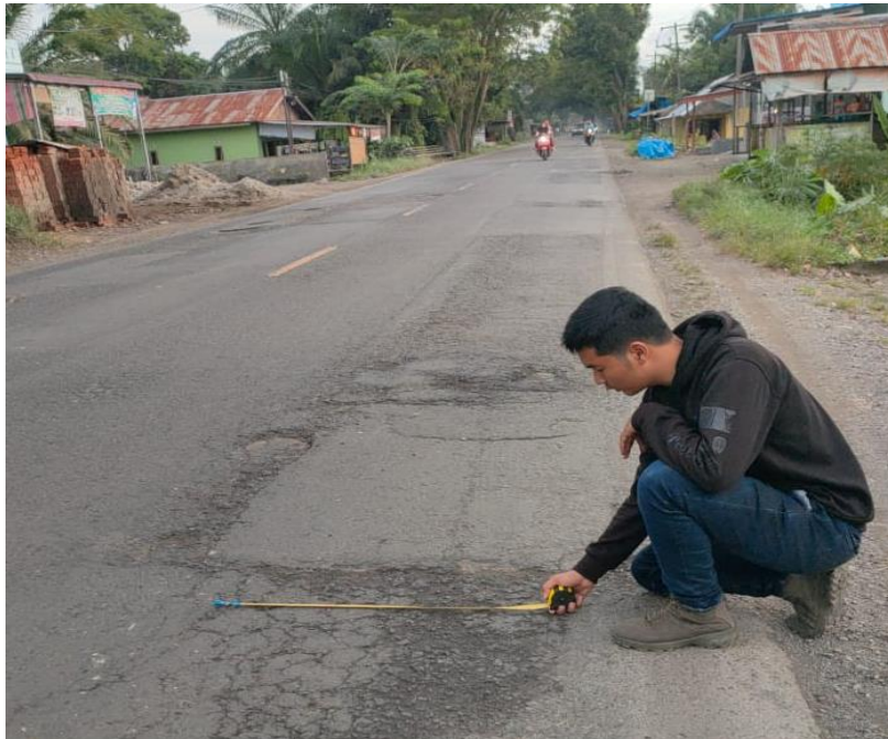
Gambar L.5: Foto Saat pengukuran Luas Retak Buaya.
