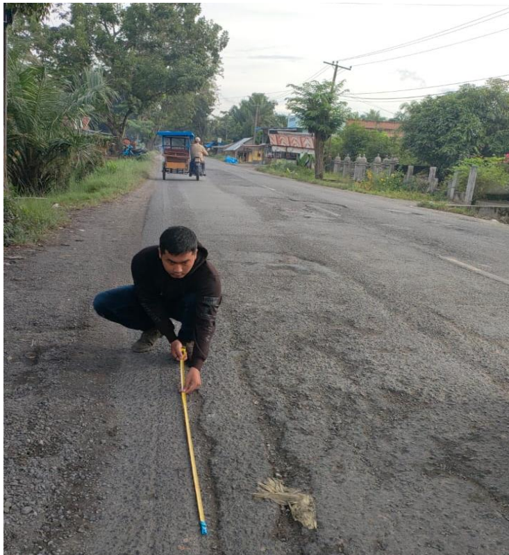
Gambar L.4: Foto Saat pengukuran Luas Kerusakan Alur.
