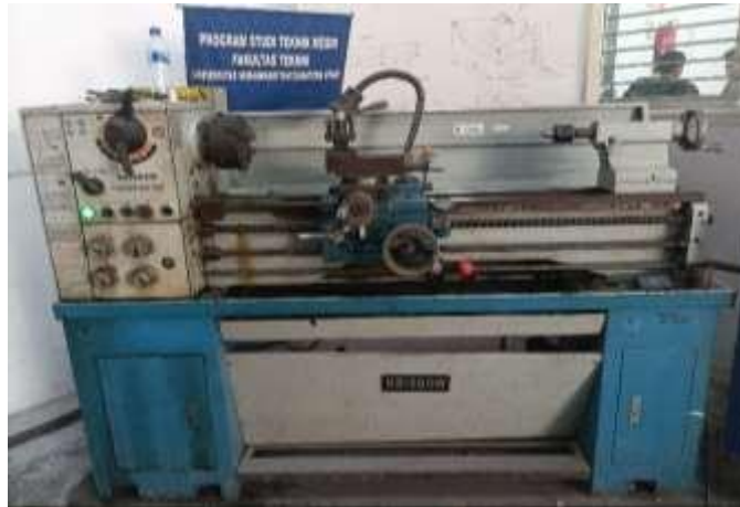
Gambar 3.1 Mesin Bubut Krisbow C063AX1000
