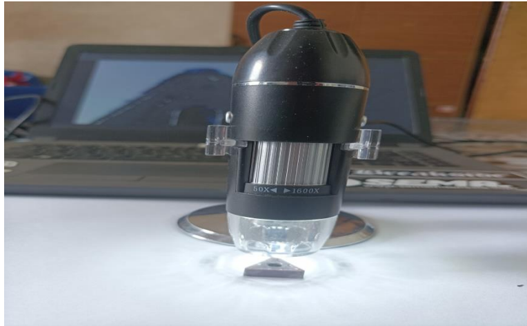
Gambar pengamatan menggunakan mikroskop digital pada mata pahat setelah dilakukan pembubutan menggunakan coolant dromus dan tidak menggunakan coolant .
