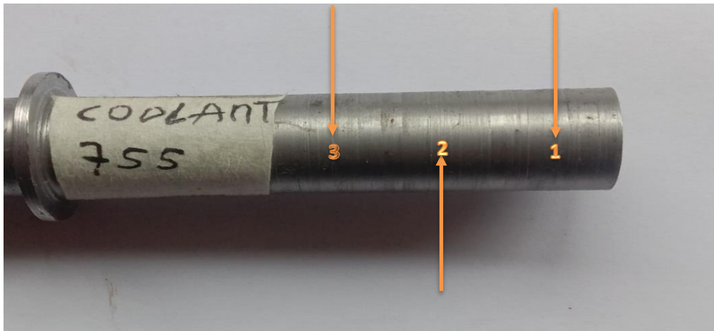
Gambar 4.1 Titik 1, titik 2, dan titik 3 pada benda kerja saat pengujian surface roughness tester .
