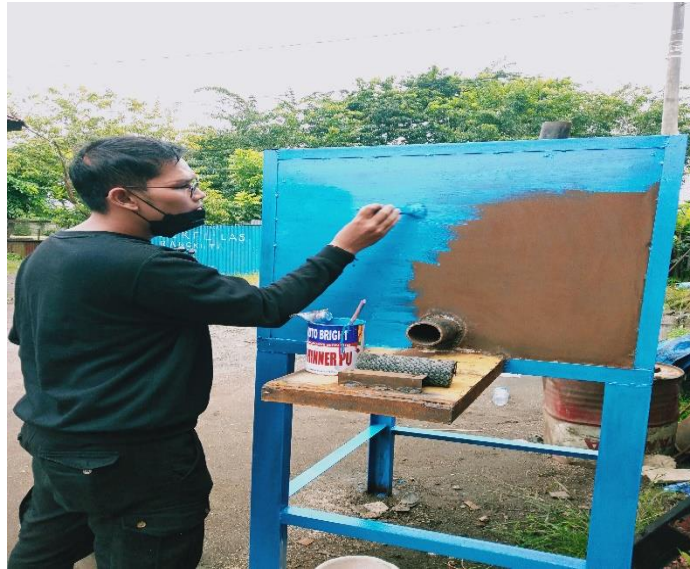
Gambar 4.9 proses pengecatan tungku
