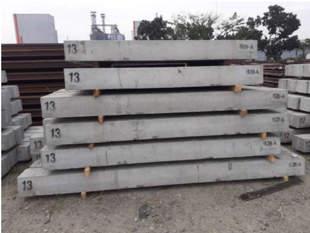
Lampiran 6. Bantalan Beton untuk Wesel R.54.
