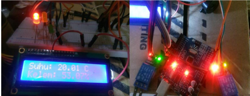
a. LED Merah Menyala Dibawah Kelembapan dan Temperatur Ideal
