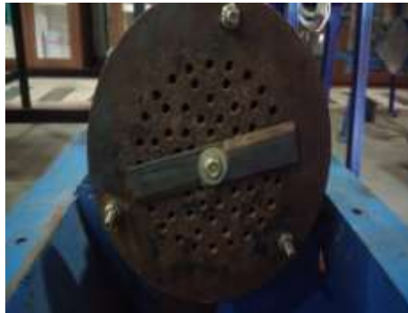
Gambar 3.12 Pisau atau mata pencetak pelet
