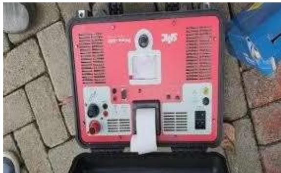
Gambar 3.2 MicroOhmMeter merk AG POWER
