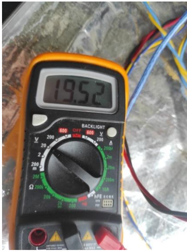
Gambar 4.2 Proses pengukuran tegangan panel surya dan turbin ventilator
