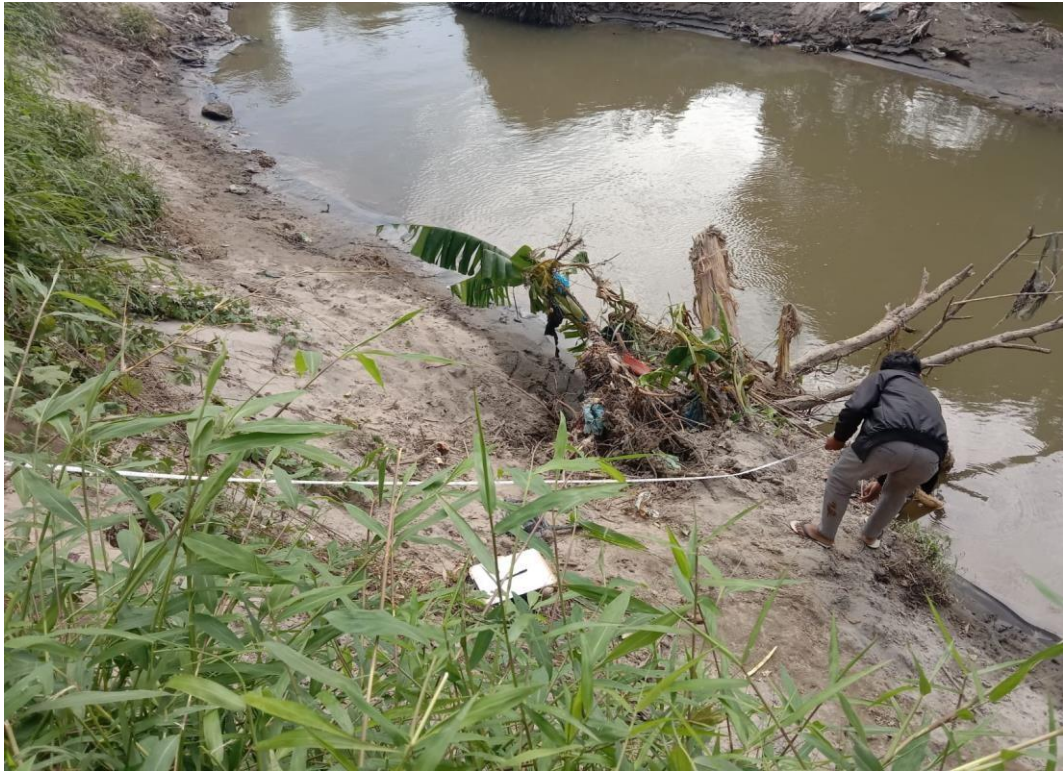
Gambar L. 3: Mengukur Kemiringan Longsor.
