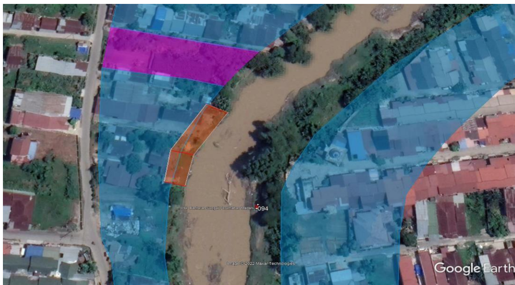
Gambar 4. 29: Lokasi Bangunan Melewati Batas Garis Sempadan.
