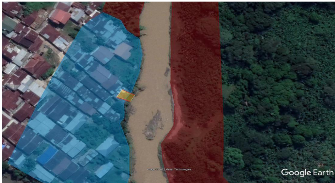
Gambar 4. 23: Lokasi Bangunan Melewati Batas Garis Sempadan.
