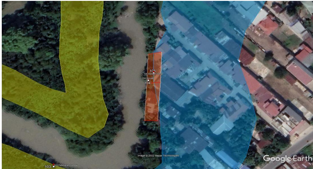
Gambar 4. 30: Lokasi Bangunan Melewati Batas Garis Sempadan.
