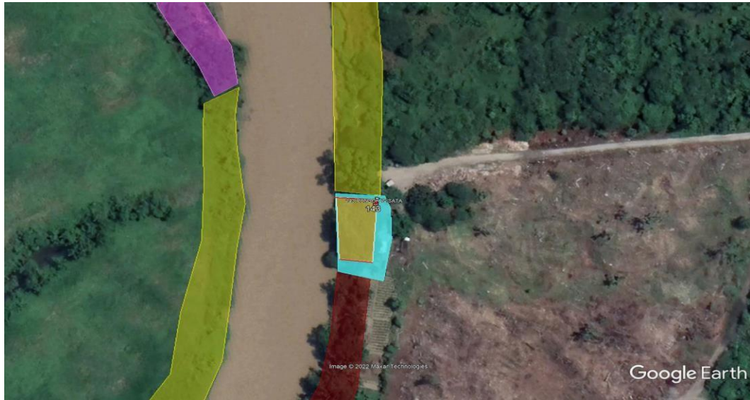
Gambar 4. 16: Lokasi Bangunan Melewati Batas Garis Sempadan.
