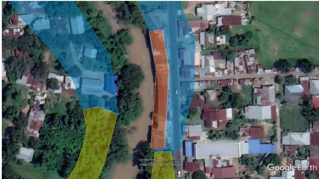
Gambar 4. 32: Lokasi Bangunan Melewati Batas Garis Sempadan.
