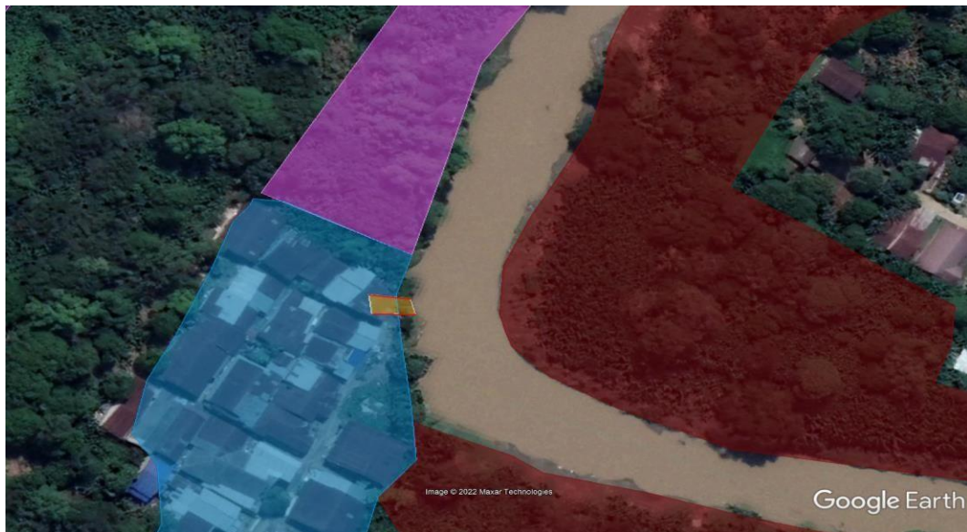
Gambar 4. 21: Lokasi Bangunan Melewati Batas Garis Sempadan.
