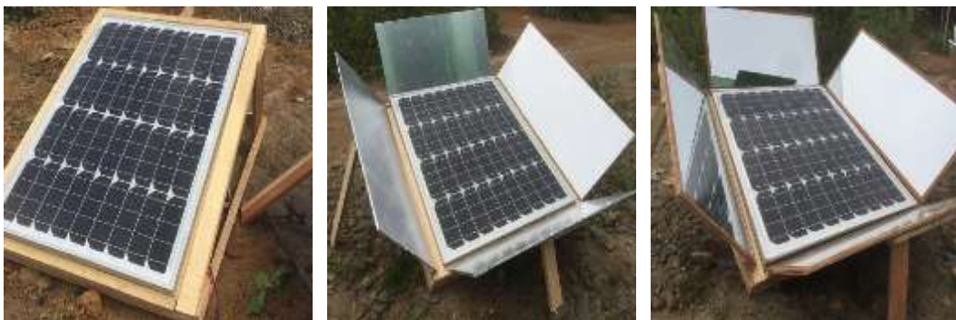
Gambar 4. 40 Panel surya dengan sudut reflektor 45 0
