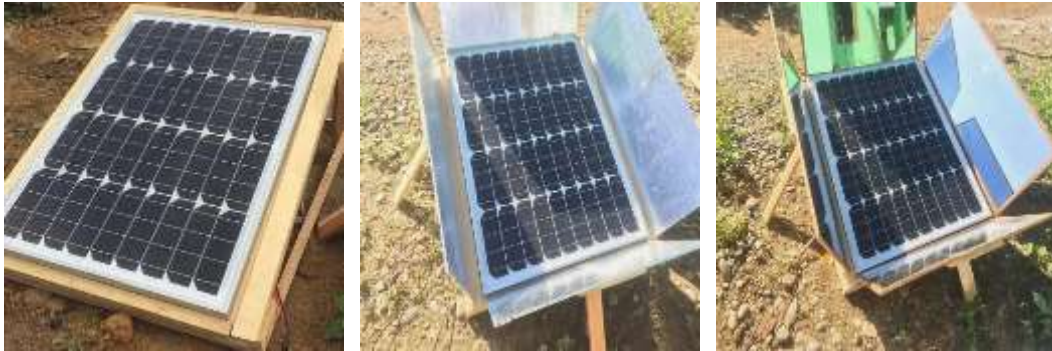
Gambar 4. 25 Panel surya dengan sudut reflektor 60^{\circ}
