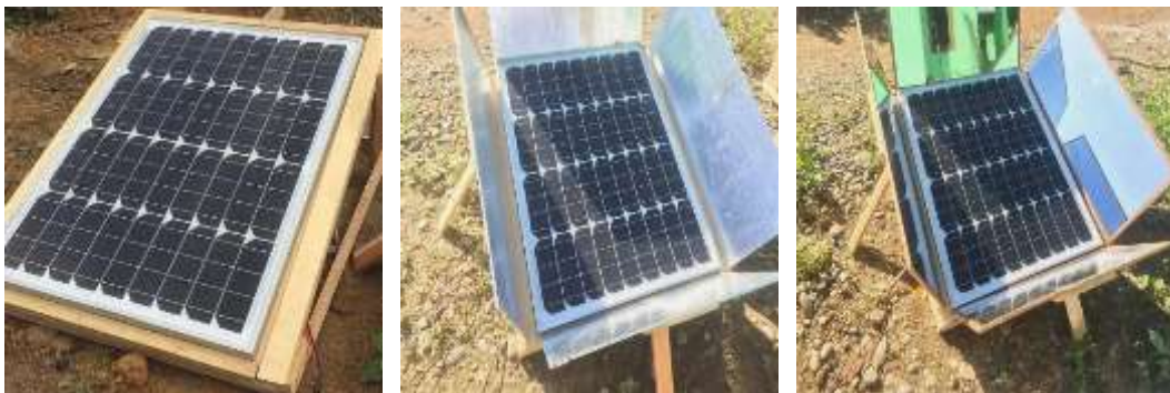
Gambar 4. 34 Panel surya dengan sudut reflektor 60^{\circ}
