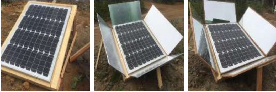
Gambar 4. 4 Panel surya dengan sudut reflektor 45^\circ
