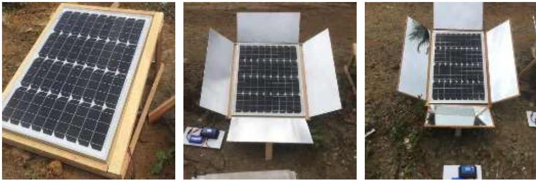
Gambar 4. 19 Panel surya dengan sudut reflektor 30 0
