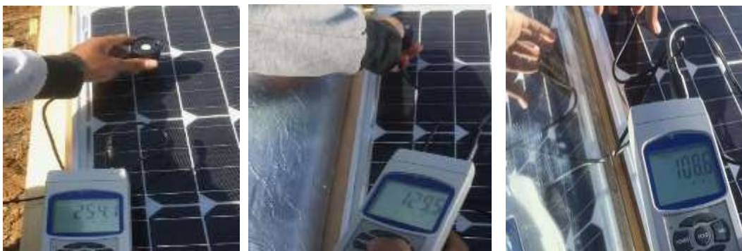
Gambar 4. 7 Panel surya dengan sudut reflektor 60^{\circ}
