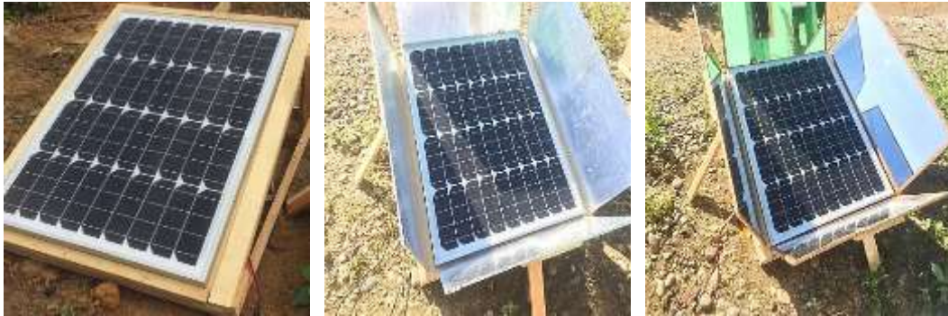
Gambar 4. 7 Panel surya dengan sudut reflektor 60^{\circ}
