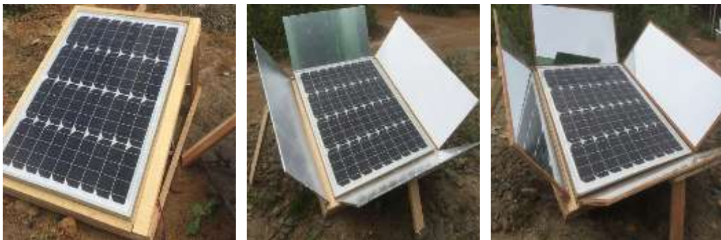
Gambar 4. 31 Panel surya dengan sudut reflektor 45 0
