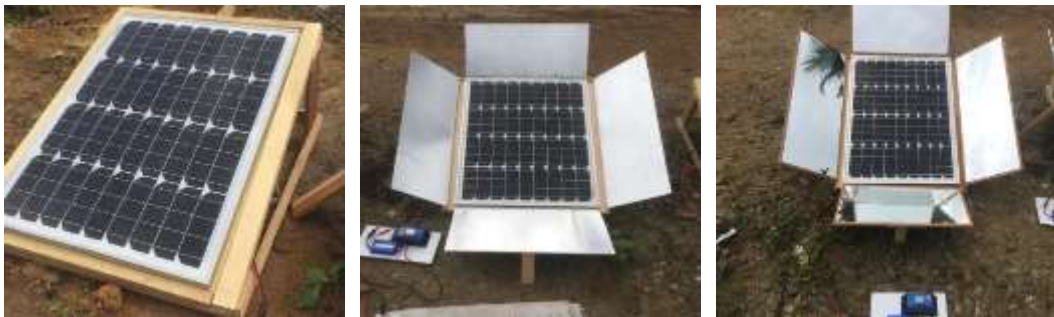
Gambar 4. 1 Panel surya dengan sudut reflektor 30^{\circ}
