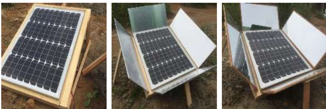
Gambar 4. 22 Panel surya dengan sudut reflektor 45 0
