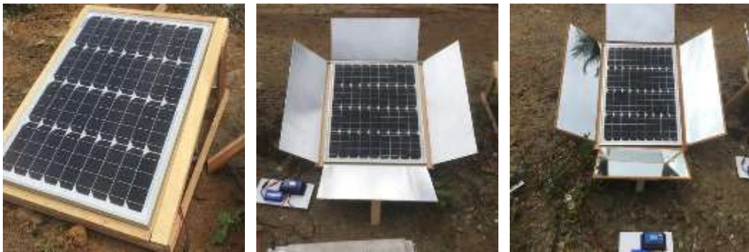
Gambar 4. 10 Panel surya dengan dengan sudut reflektor 30 0
