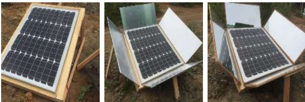
Gambar 4. 13 Panel surya dengan dengan sudut reflektor 45 0
