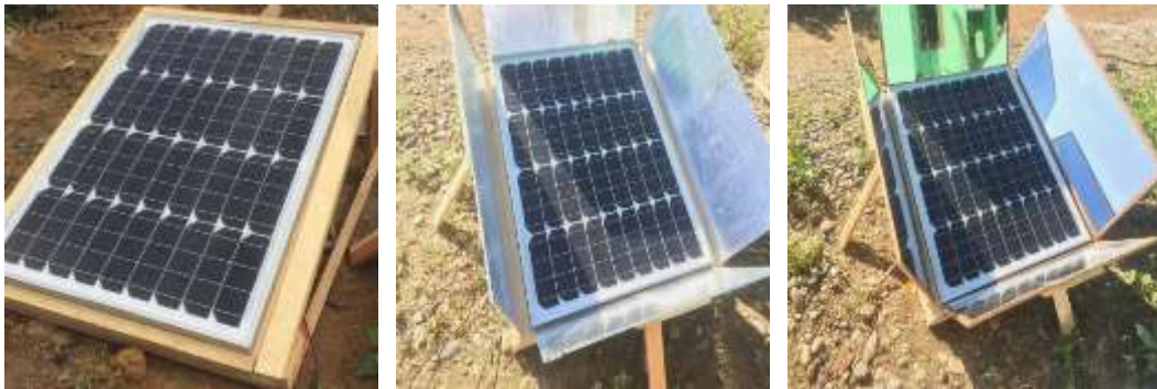
Gambar 4. 16 Panel surya dengan sudut reflektor 60^{\circ}
