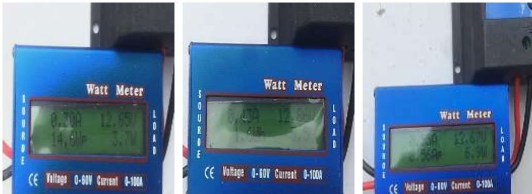
Gambar 4. 28 Panel surya dengan sudut reflektor 30°
