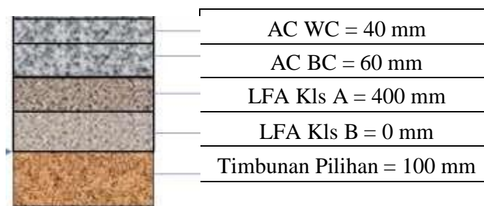
Gambar 4.2: Detail Perkerasan Metode Bina Marga 2017
