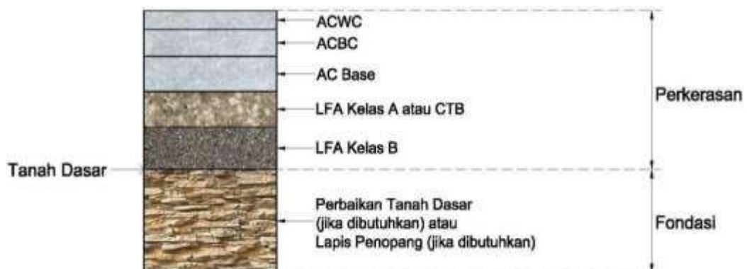
Gambar 2.2: Struktur Perkerasan Lentur (Kementerian Pekerjaan Umum dan Perumahan Rakyat; Direktorat Jenderal Bina Marga, 2017)
