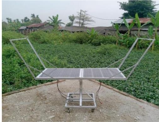
Gambar 3.4 Rangka dudukan Panel surya dan Reflector
