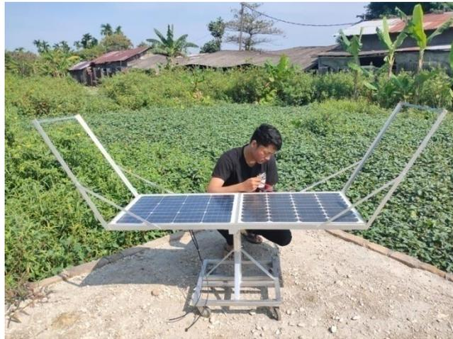
Gambar 2. Pengukuran Tanpa menggunakan Reflector Cermin Datar
