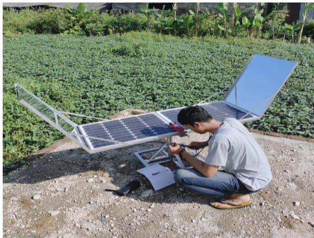
Gambar 3. Pengukuran menggunakan Reflector Cermin Datar
