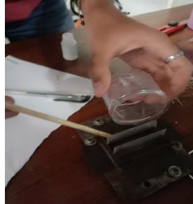
Gambar 3.58 Menuangkan Kembali Sisa Campuran Resin dan Katalis Kedalam Cetakan Uji Impact
