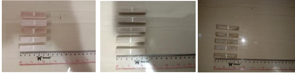
Gambar 3.64 Spesimen Uji Impact
