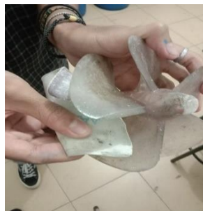
Gambar 3.48 Mengamplas Sudu-Sudu Turbin Kaplan
