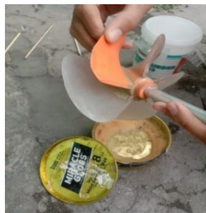
Gambar 3.34 Mengoleskan Mirror Glaze ke Sudu dan Poros Turbin Kaplan
