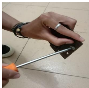
Gambar 3.59 Membuka Baut Pengunci Dicetakan Spesimen Uji Impact
