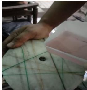
Gambar 3.46 Memasukkan Resin dan Katalis Kecetakan
