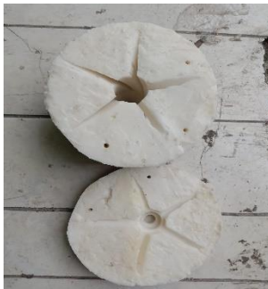
Gambar 3.40 Hasil Pembuatan Molding Sudu-Sudu Turbin Kaplan
