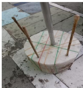
Gambar 3.43 Menutup Bagian Atas Molding dan Memberinya Karet
