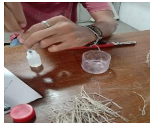
Gambar 3.53 Mengukur Volume Resin dan Katalis
