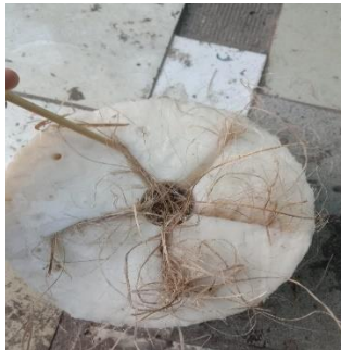
Gambar 3.42 Memasukkan Serat Batang Pisang Keceratan
