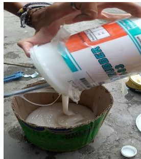
Gambar 3.37 Memasukkan Silicone Rubber dan Hardener Kedalam Cetakan Kardus
