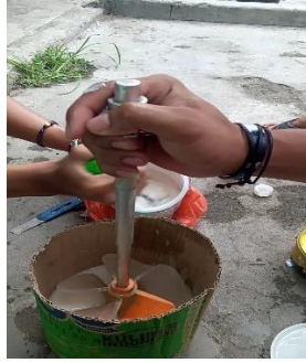
Gambar 3.38 Memasukkan Sudu-Sudu Turbin Kaplan Kedalam Kardus
