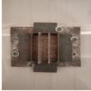
Gambar 3.7 Cetakan spesimen uji impact adapun jenis besi yang digunakan untuk cetakan spesimen uji impact ini adalah mild steel .
