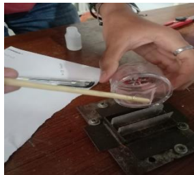
Gambar 3.56 Penuangan Lapisan Pertama Antara Resin dan Katalis
