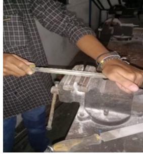
Gambar 3.61 Membuat Sudut Takik Pada Spesimen Uji Impact
