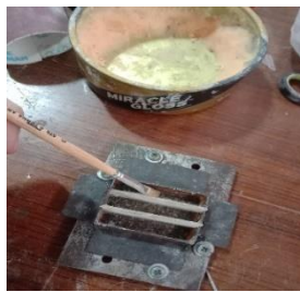
Gambar 3.52 Melapisi Cetakan Spesimen Dengan Mirror Glaze
