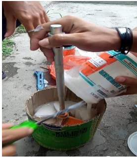
Gambar 3.39 Menuangkan Sisa Campuran Silicone Rubber dan Hardener Kedalam Cetakan Kardus
