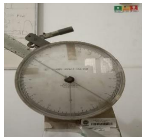
Gambar 3.67 Melihat Sudut Akhir Pada Indikator Alat Uji Impact
