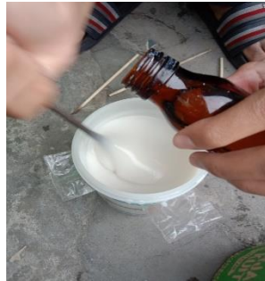
Gambar 3.36 Mengaduk Silicone Rubber dan Hardener
