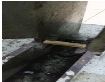
Gambar 3.66 Proses Pengujian Spesimen Impact
