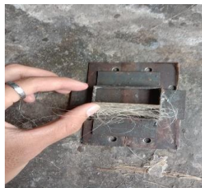
Gambar 3.57 Memasukkan Serat Batang Pisang Kecetakan Uji Impact
