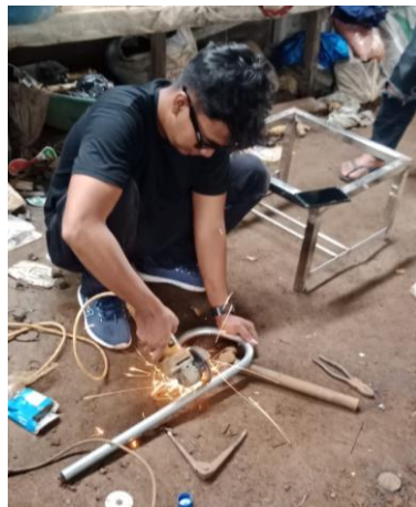
Gambar 4.7. Proses Pemotongan Dengan Menggunakan Gerinda Tangan
