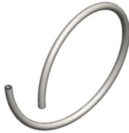
Gambar 4.5. Desain Pipa 870 mm Yang Telah Di Roll Bending
