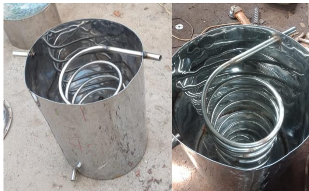
Gambar 4.14. Hasil Penyambungan Pipa Penyalur Dan Tabung Kondensasi
