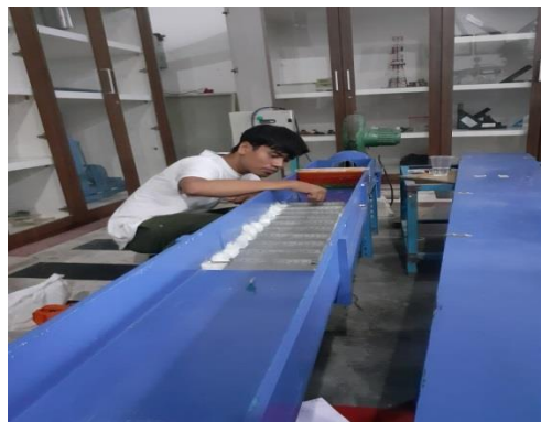
Gambar 3.15 Pemasangan rusuk pada base plate
