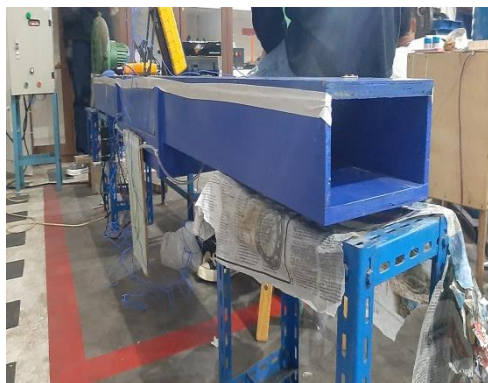
Gambar 3.2 Saluran Udara Segiempat
