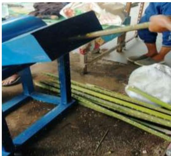
Gambar 4.4 Proses memasukkan pelepah sawit
