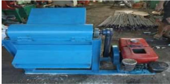
Gambar 3.2 Mesin Pencacah pelepah sawit
