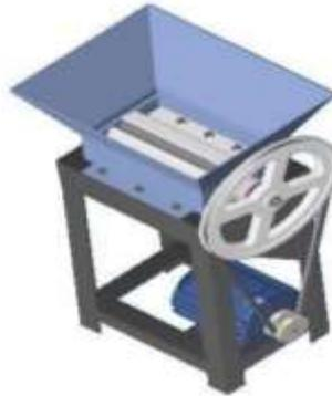
Gambar 2.2 Mesin Pencacah Plastik (Azhari, 2018)
