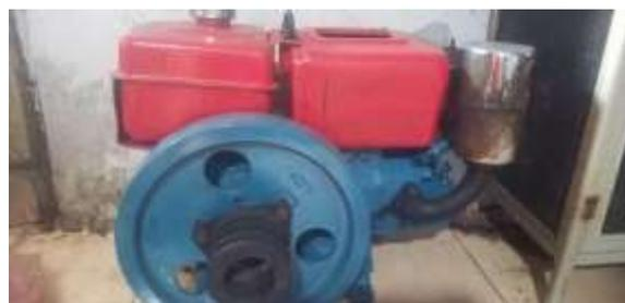
Gambar 2.9 Motor penggerak (Untung dkk, 2018)
