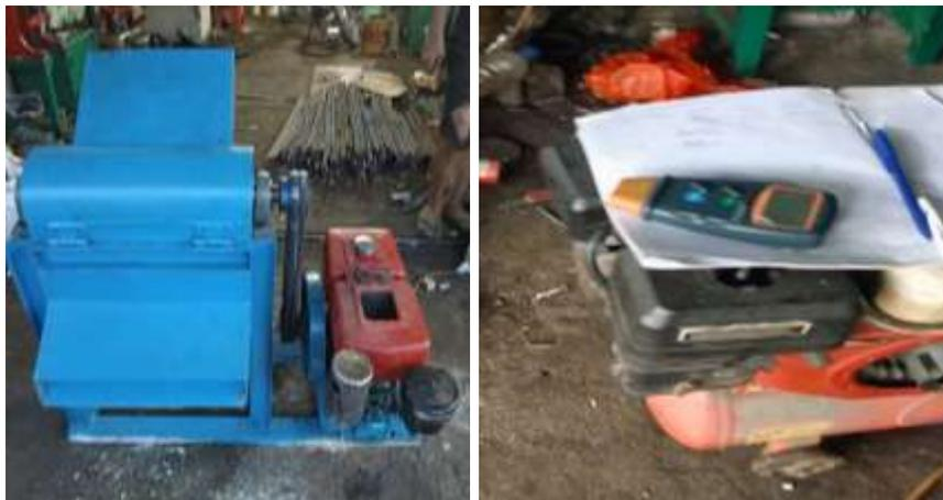
Gambar 4.1 Mesin Pencacah dan tachometer
