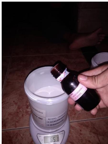
Gambar 4.22. Proses pencampuran hardener dengan silicon rubber
