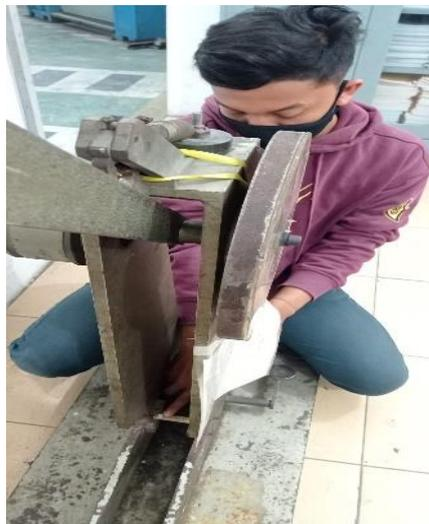
Gambar 4.8. Peletakan Spesimen Pada Penopang
