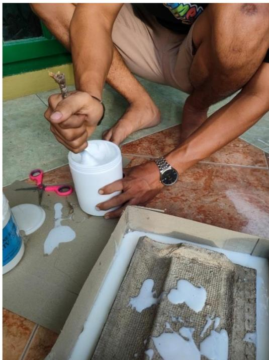
Gambar 4.24. Menuangkan Campuran Silicon Rubber ke Dalam Cetakan
