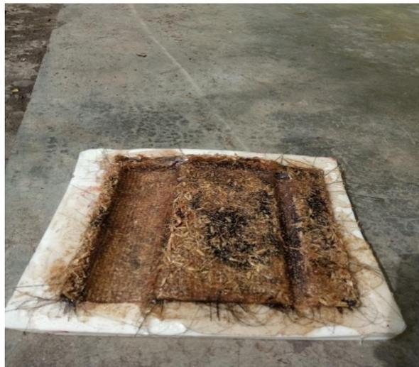
Gambar 4.28. Meletakkan Serat Ijuk Dan Sekam Padi Kedalam Cetakan
