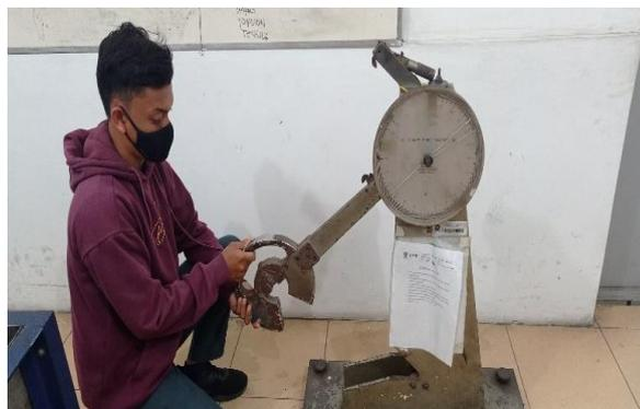
Gambar 4.10. Proses Pengangkatan Lengan Bandul
