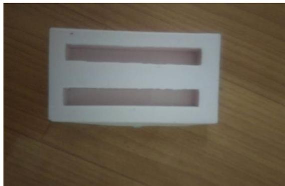
Gambar 3.3 Cetakan spesimen uji impact
