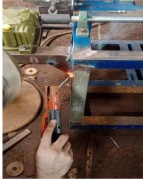
Gaambar 4.17 Pengelasan Rangka Dudukan Gearbox ke Rangka Utama
