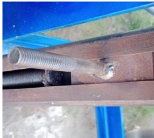
Gambar 4.70 Besi Hollow Dan As Drat Setelah di Las
