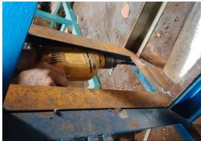
Gambar 4.27 Proses Membuat Lubang Baut
