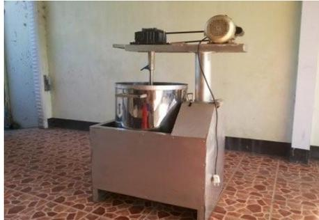
Gambar 2.4 wadah menggunakan *stainless steel* (Alit et al., 2019)
