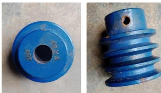
Gambar 4.89 *pully* mesin yang sudah di bubut
