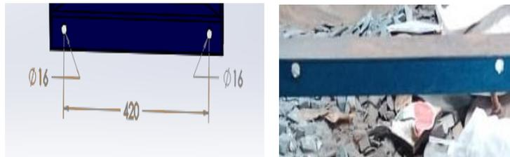
Gambar 4.9 Rancangan dan Hasil Pembuatan Lubang Baut Rangka Pengaduk dan Penggiling.
