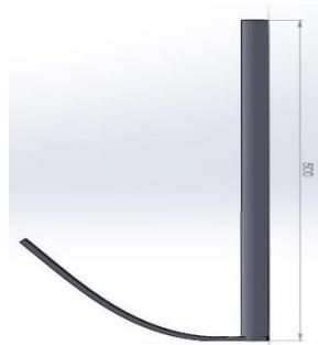
Gambar 2.3 pengaduk menggunakan *Pitch Blade Impeller* (Sifa et al., 2020)
