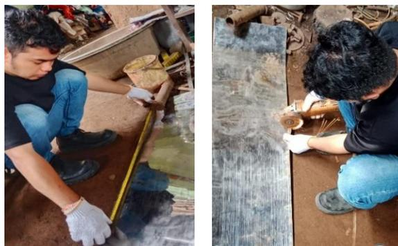
Gambar 4.32 Proses Pengukuran dan Pematangan Plat *Stainless Steel*
