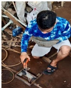
Gambar 4.13 Pengelasan Rangka Dudukan *Gearbox*
