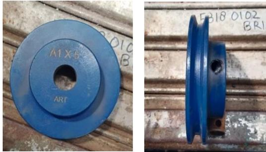
Gambar 4.90 *Pully* As bantu yang sudah di bubut
