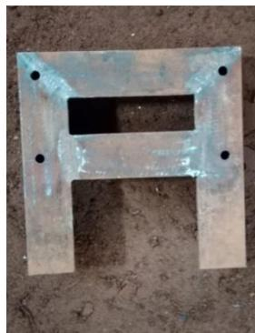
Gambar 4.16 Rangka Dudukan *Gearbox*
