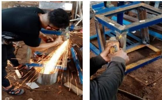
Gambar 4.6 Peroses Pembersihan Sisa Pengelasan Menggunakan Gerinda
