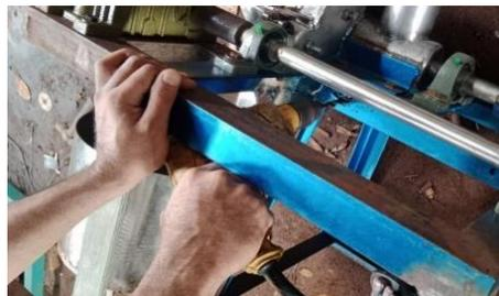
Gambar 4.7 Proses Pengeboran Rangka
