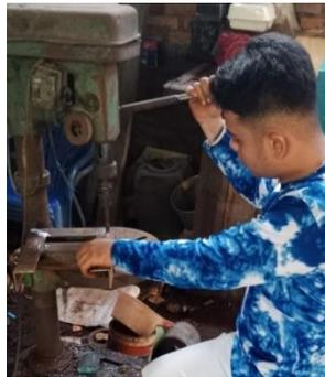
Gambar 4.15 Pengeboran Lubang Baut Dudukan *Gearbox*
