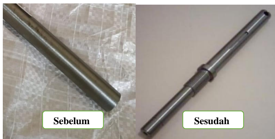
Gambar. 2.13 Poros besi As sebelum dilakukan bubut dan sesudah dilakukan pembubutan.
