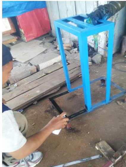
Gambar 4.13 Proses Pengecatan Rangka
