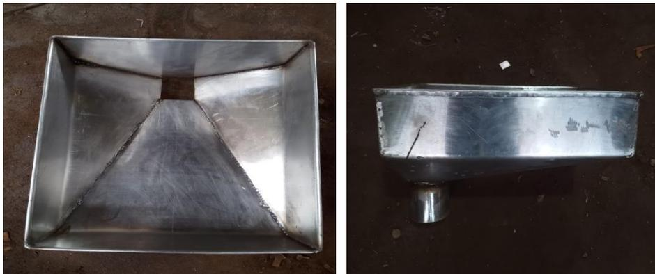
Gambar 4.41 Hasil pengelasan *hopper*
