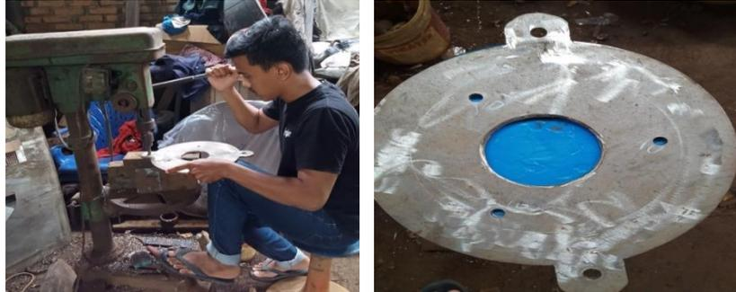
Gambar 4.23 Proses pembuatan lubang
