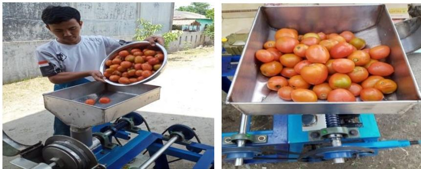
Gambar 4.103 Buah tomat 5 Kg dimasukkan ke dalam *hopper*.
