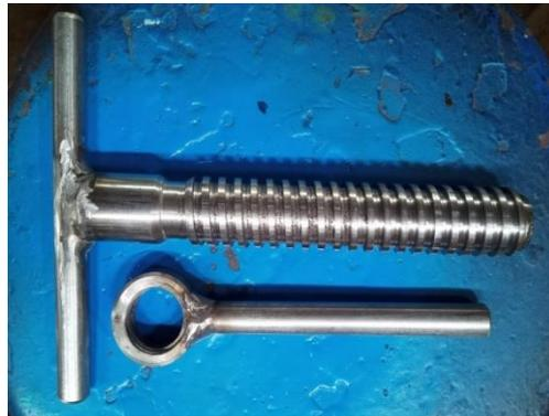
Gambar 4.65 Hasil pembuatan stelan batu penggiling
