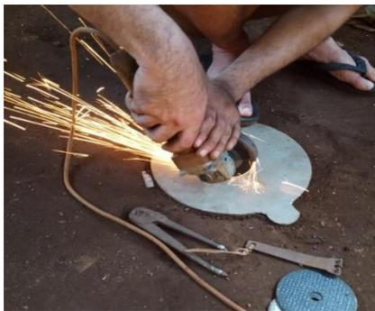
Gambar 4.21 Proses pemotongan plat dudukan batu diam
