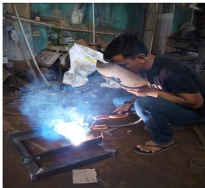
Gambar 4.4 Proses pengelasan rangka atas dan bawah
