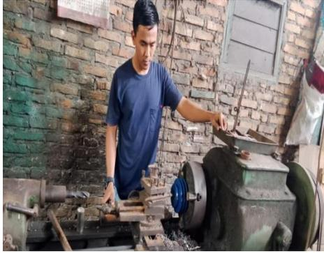
Gambar 4.74 Proses pembubutan pully
