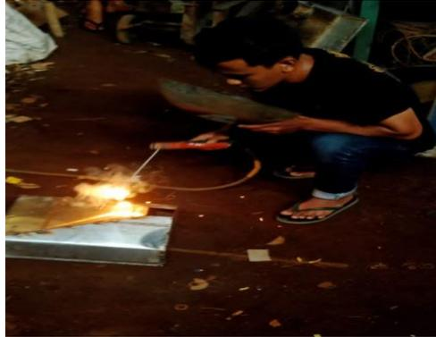
Gambar 4.40 Proses pengelasan *hopper*
