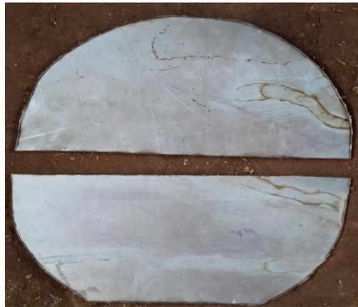
Gambar 4.46 Hasil plat penutup batu yang sudah dipotong
