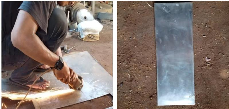
Gambar 4.35 Proses pemotongan plat stainless steel
