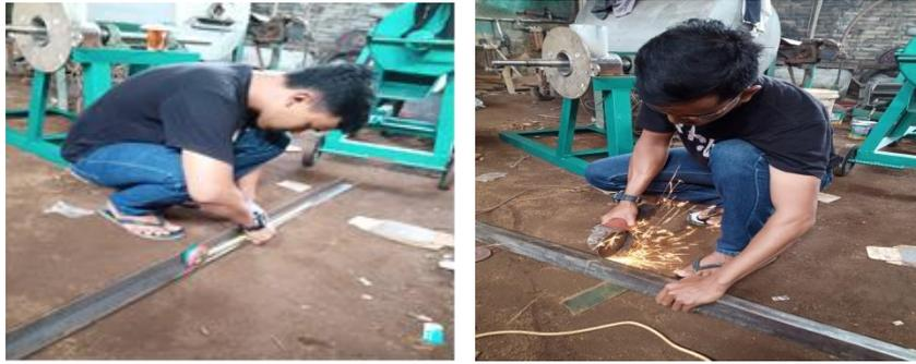
Gambar 4.3 Proses pengukuran dan Proses pemotongan
