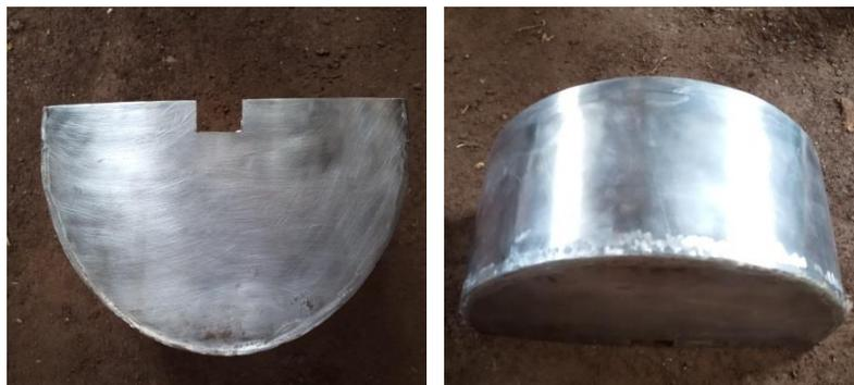
Gambar 4.52 Hasil pengelasan penutup batu
