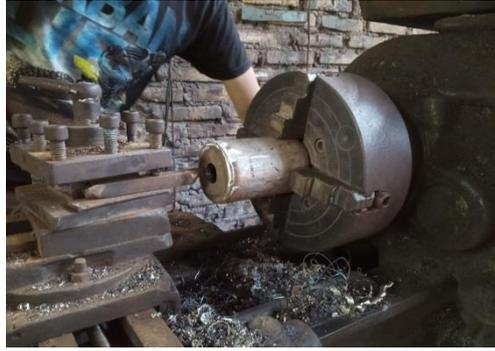
Gambar 4.59 Proses merapikan pengelasan dan pembuatan lubang
