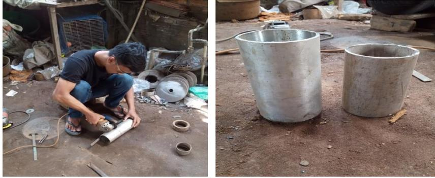
Gambar 4.10 Proses pemotongan pipa *stainless steel*
