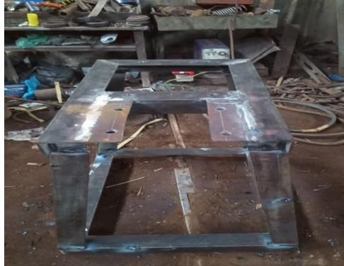
Gambar 2.4 Rangka Mesin Penggiling Buah Tomat
