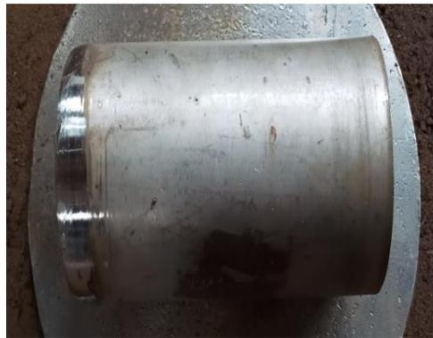
Gambar 4.60 Hasil meratakan pengelasan dan pembuatan lubang
