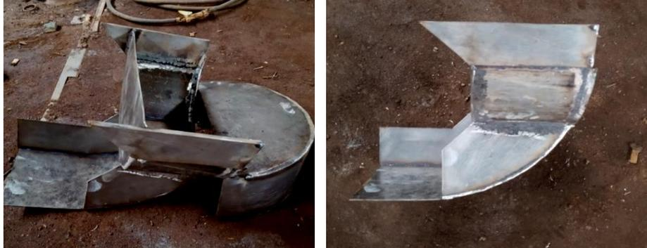
Gambar 4.56 Hasil penyambungan corong dengan penutup batu
