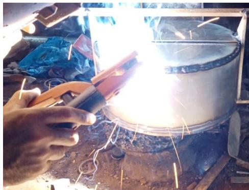
Gambar 4.51 Proses pengelasan penutup batu
