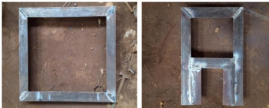
Gambar 4.5 Hasil pengelasan rangka atas dan bawah
