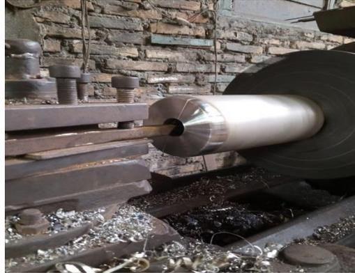
Gambar 4.13 Proses pembuatan lubang as
