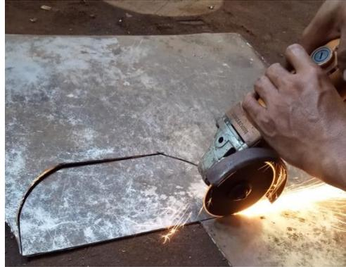
Gambar 4.45 Proses pemotongan plat penutup batu bawah
