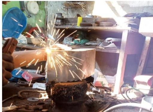
Gambar 4.54 Proses pengelasan corong
