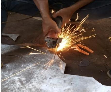
Gambar 4.47 Proses pemotongan plat berbentuk persegi panjang
