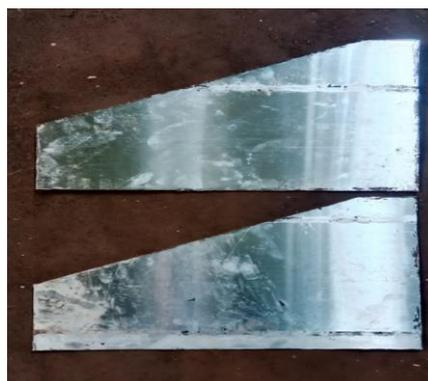
Gambar 4.36 Hasil plat yang telah dipotong untuk sisi kiri dan kanan
