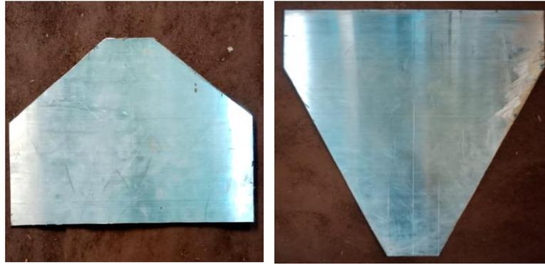
Gambar 4.37 Hasil plat yang telah dipotong untuk sisi depan dan belakang
