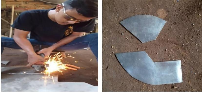
Gambar 4.53 Proses pemotongan plat corong
