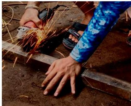
Gambar 4.17 Proses pemotongan besi siku
