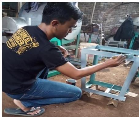
Gambar 4.84 Pengecatan dasar
