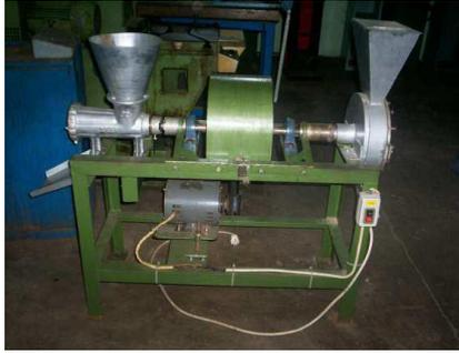
Gambar 2.2 Mesin Penggiling Bumbu (Mesin Z.A. J. T. 2015)
