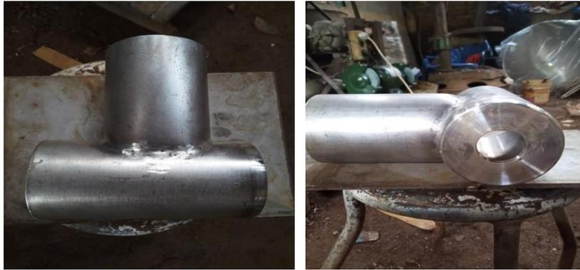
Gambar 4.15 Hasil penyambungan pipa
