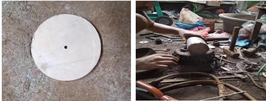
Gambar 4.11 Proses pengelasan penutup pipa
