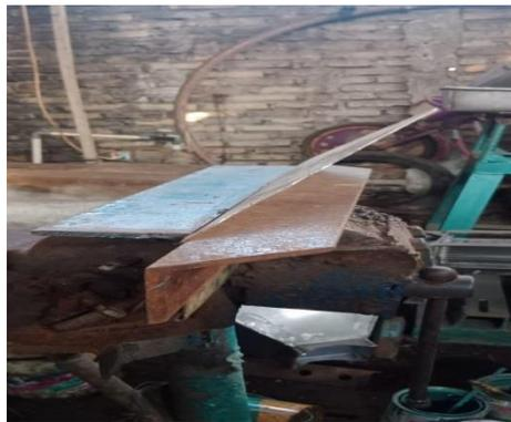
Gambar 4.38 Proses penekukan plat
