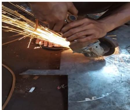
Gambar 4.44 Proses pemotongan plat
