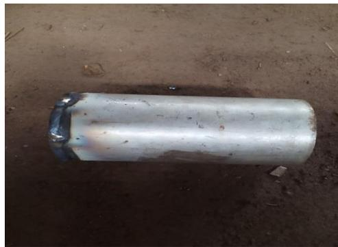
Gambar 4.12 Hasil pengelasan penutup tabung *screw*
