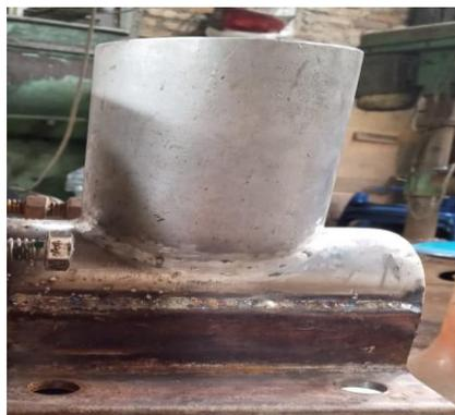
Gambar 4.19 Hasil penyambungan dudukan pipa tabung *screw*
