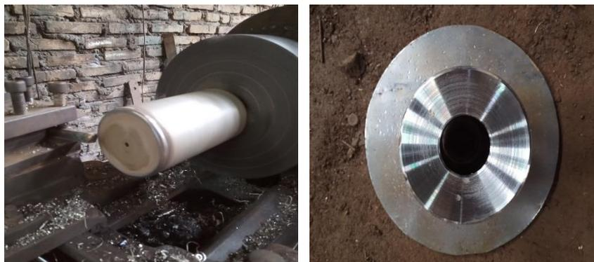
Gambar 4.14 Hasil merapikan pengelasan dan pembuatan lubang
