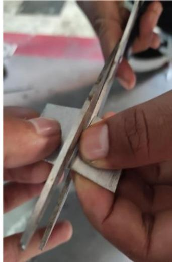
Gambar 3.4 Pemotongan sirip kondensor
