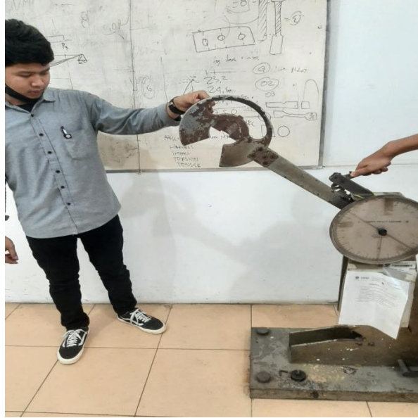
Foto Pengujian Spesimen dengan uji impak Charpy
