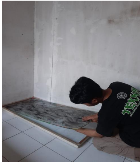
Gambar 4.6 Melepaskan Door Trim dari Cetakan
