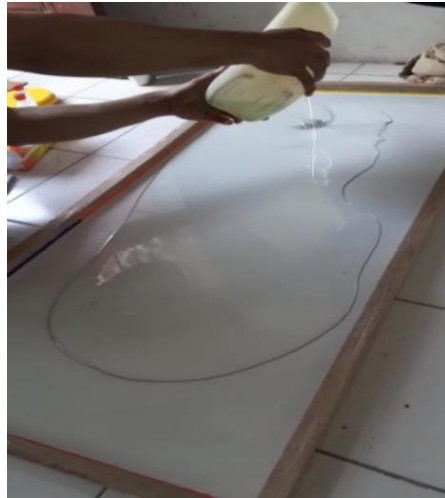
Gambar 4.5 Menuang Resin ke Dalam Cetakan
