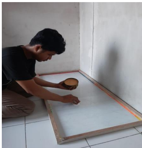
Gambar 4.3 Melapisi Permukaan Cetakan
