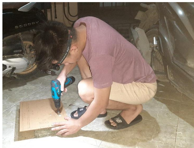
Gambar proses melubangi akrilik bagian depan
