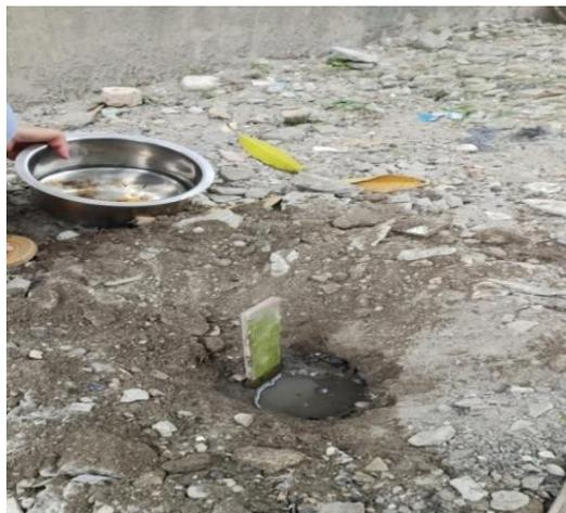
Lampiran 5 : Pengujian Laju Resapan Air Kedalam Tanah
