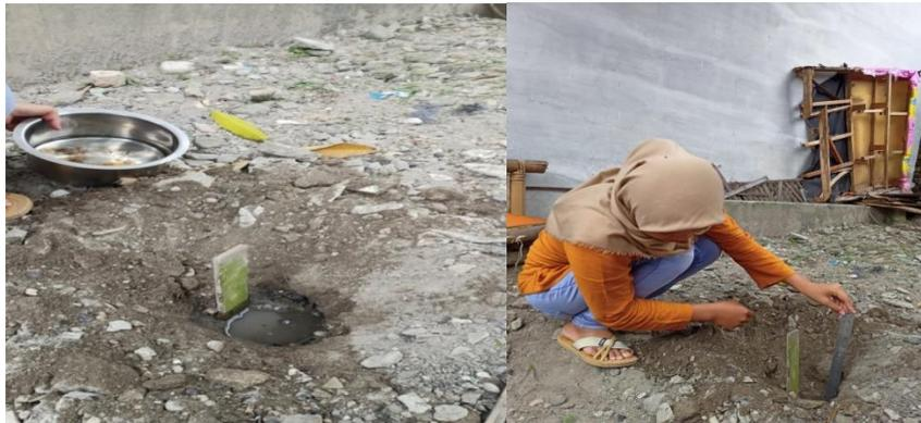
Gambar 3.5: Percobaan infiltrasi tanah
