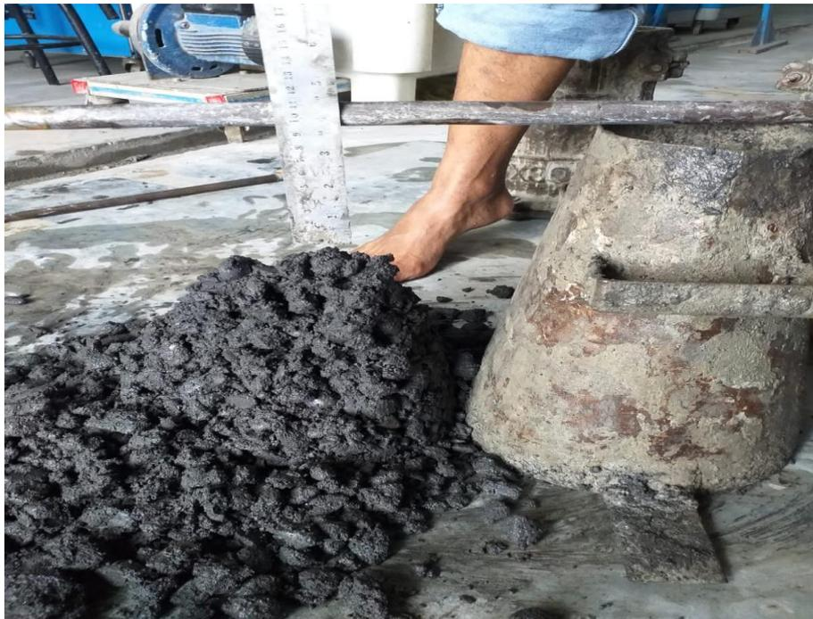
Gambar lampiran 8. Hasil pengujian slump
