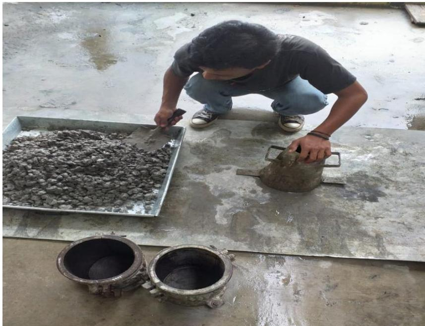
Gambar lampiran 6. Proses pencetakan campuran beton
