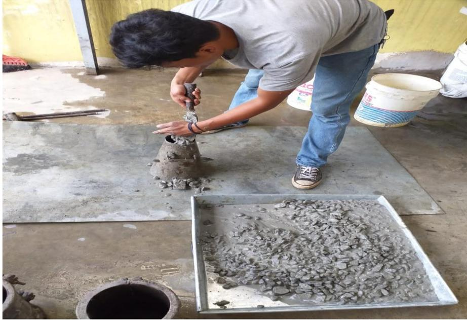
Gambar lampiran 7. Proses pengujian slump
