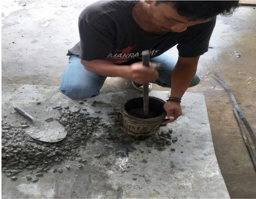
Gambar lampiran 9. Proses pengisian campuran kedalam cetakan beton
