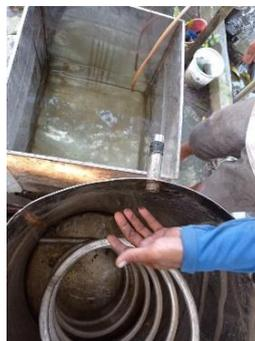
Gambar 3.15 Bak air dan kondensor
