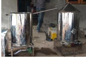
Gambar 3.19 Pipa ketel ke pipa spiral
