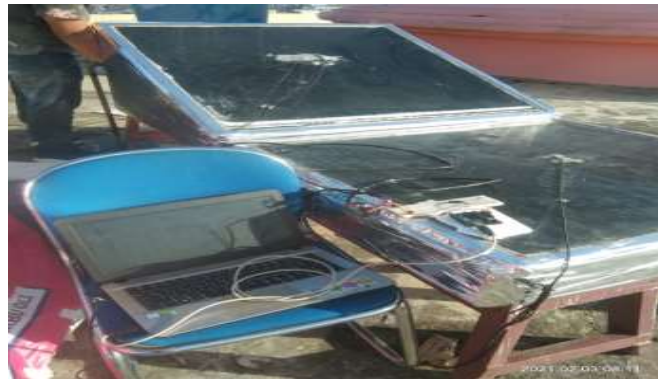
Gambar 4.15 Merekam dengan menggunakan termokopel
