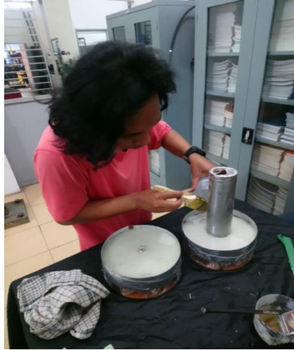
Gambar 4.5 Menuang Resin ke Dalam Cetakan
