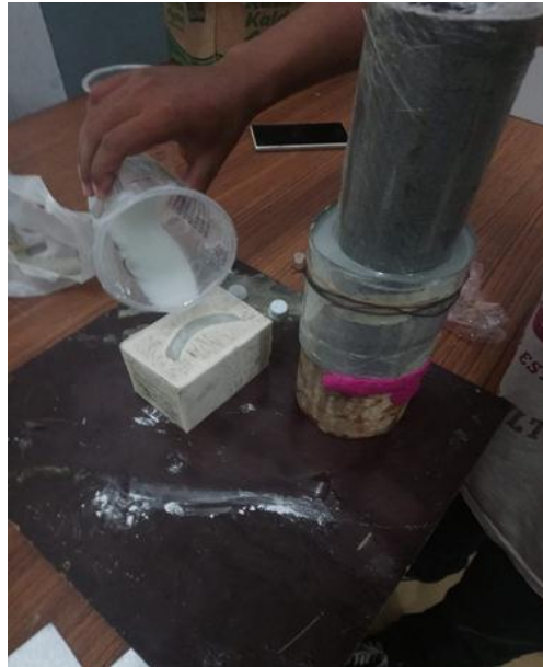
Gambar 4.11 Menuangkan Resin ke Dalam Cetakan
