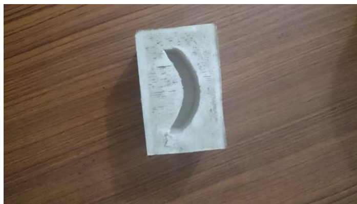
Gambar 4.10 Hasil Cetakan Sudu dari Silicon Rubber
