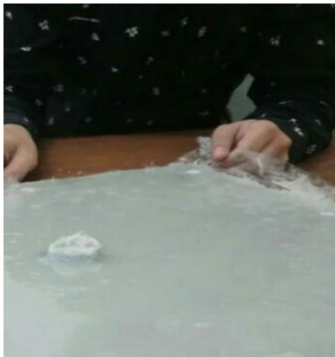
Gambar 4.6 Melepaskan Plat Impeller dari Cetakan
