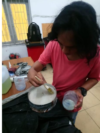
Gambar 4.3 Melapisi Permukaan Cetakan
