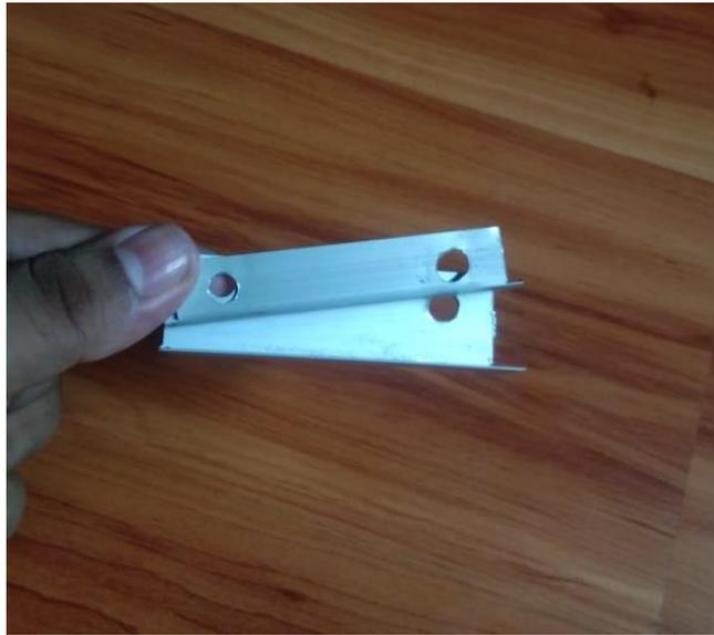
Gambar 3.11 Alumunium Dudukan Turbin
