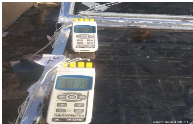
Gambar 4.5 Temperatur dibaca melalui termokopel
