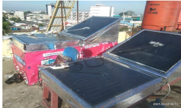
Gambar 4.1 Rancangan alat desalinasi air laut dengan menggunakan ketebalan kaca 4 mm dan kaca 5 mm
