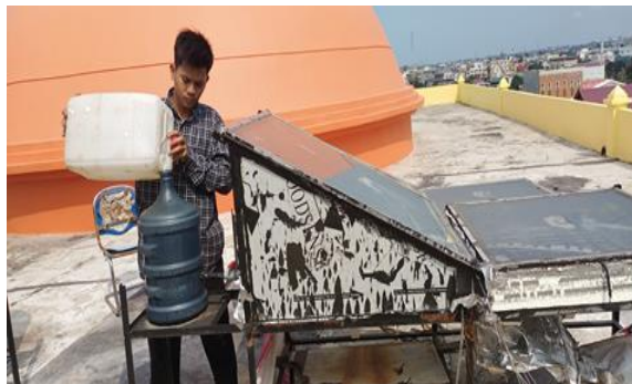
Gambar 4.2 Pengisian air laut kedalam tangki penampungan.
