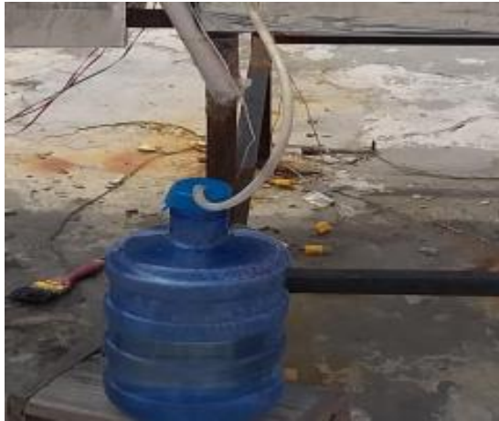
Gambar 3.7 Tangki Penampung Air Tawar Hasil Desalinasi.
