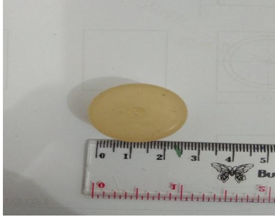
gambar 4.35. Hasil dari proses cetakan ( mold ) Core dan Cavity dop pipa plastik
