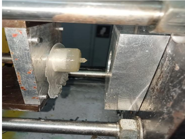
Gambar 4.12 Melakukan pengujian terhadap mold (cetakan) dop pipa plastic
