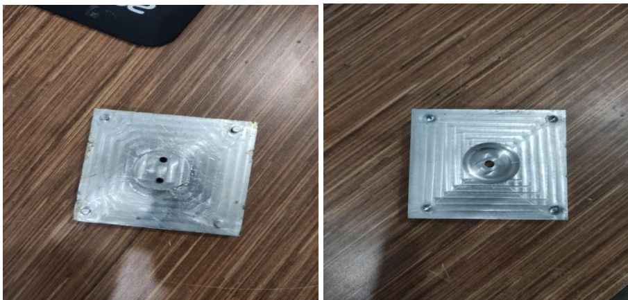
Gambar 4.34. Hasil Pembuatan Cetakan ( mold ) Core dan Cavity
