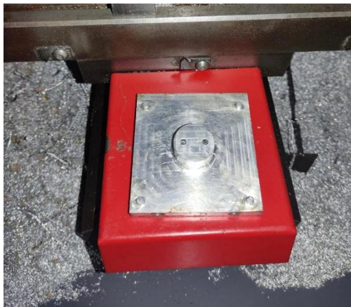
Gambar 4.11 Proses pembentukan akhir cetakan core dop pipa plastic
