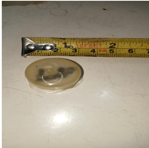
Gambar 4.31 Hasil Pendinginan 7 menit pada suhu pemanas 190°C
