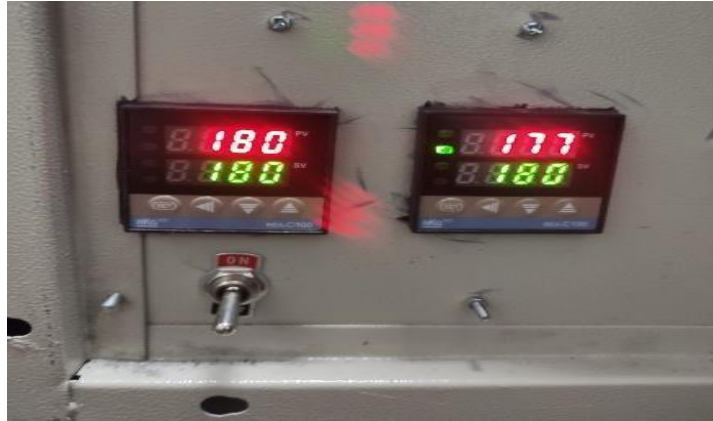
Gambar 4.14 Penyetelan suhu pada PID
