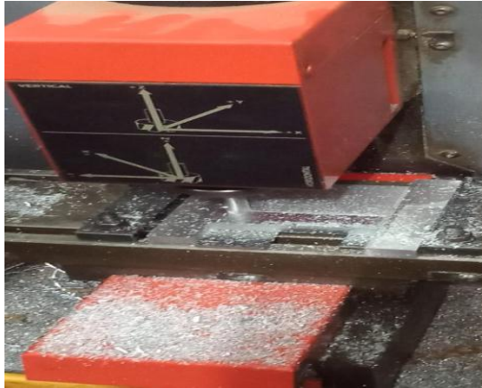
Gambar 4.10 Proses pembentukan awal cetakan core dop pipa plastik
