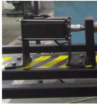
Gambar 4.51. Pemasangan Dudukan Motor Stepper 1 pada Meja.
