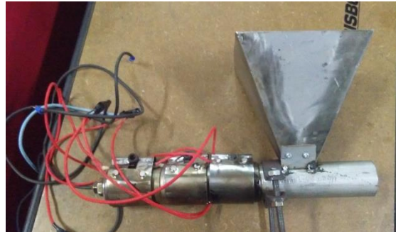
Gambar 4.46. Pemasangan Heater dan Dudukan Injection Unit .
