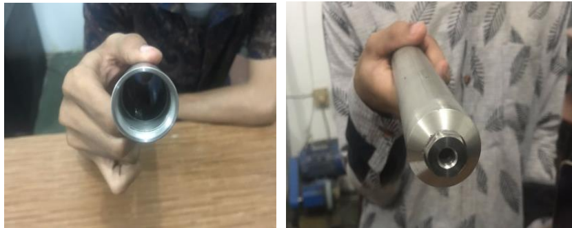
Gambar 4.43. Pemasangan Rumah Noozle .
