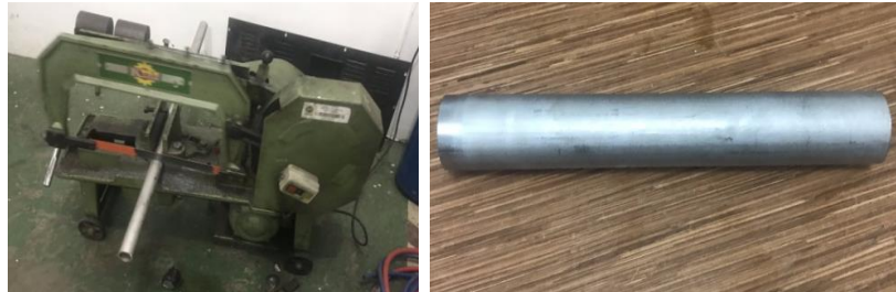
Gambar 4.1. Pemotongan Pipa Stainless Sepanjang 247 mm.
