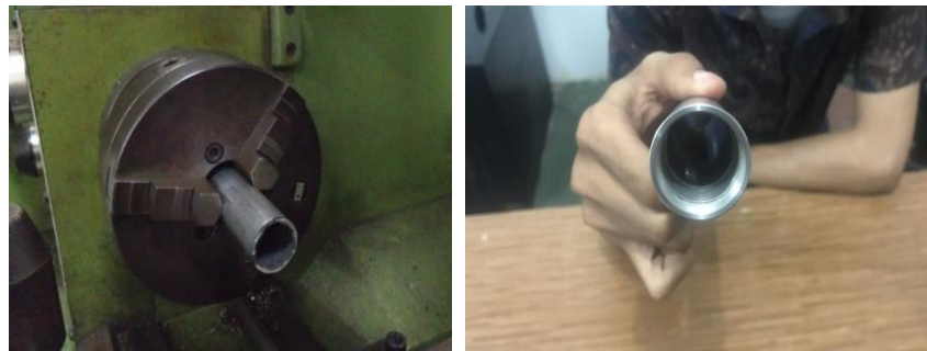
Gambar 4.4. Pembuatan Ulir 1 mm Pada Pipa Stainless
