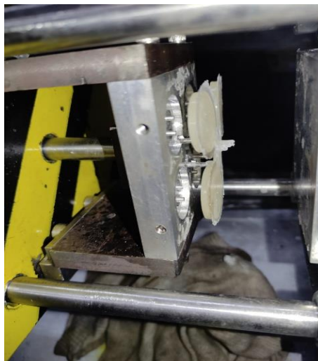
Gambar 4.72. Ejector Pin Melepaskan Hasil Cetakan.
