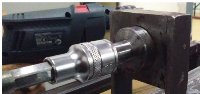
Gambar 4.49. Pemasangan Kunci Shock dan Poros Aksial
