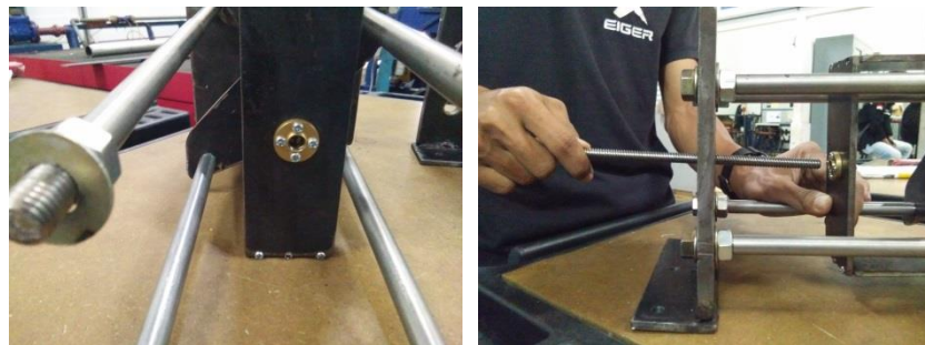
Gambar 4.55. Pemasangan Screw dan Nut .
