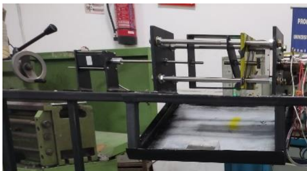
Gambar 4.58. Hasil Pemasangan Clamping Unit
