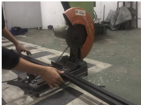
Gambar. 4.36. Pemotongan Besi Hollow
