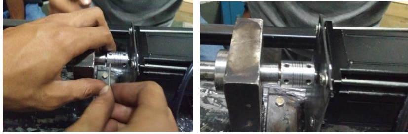
Gambar 4.50. Pemasangan Shaft flexible .
