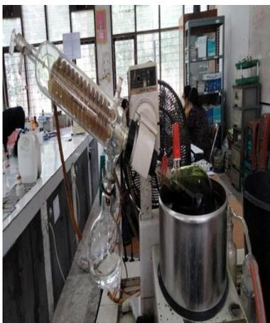
Filtrat di Rotary Evaporator
