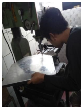
Gambar 4.53 Mengebor bagian yang di tekuk
