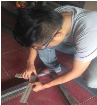
Gambar 4.6 Mengukur Besi UNP
