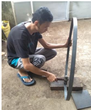
Gambar 4.19 Menekuk Bahan menjadi sebuah lingkaran
