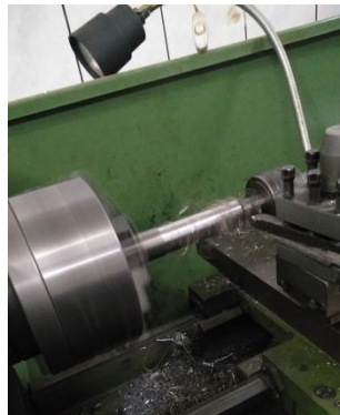
Gambar 4.29 Membubut Poros Turbin
