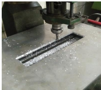
Gambar 4.50 Meratakan yang telah dibor
