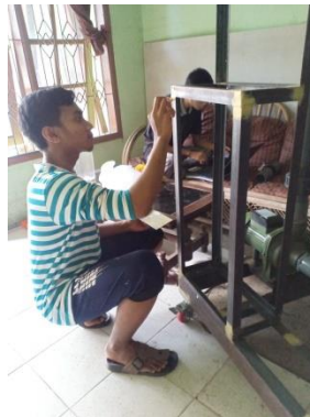
Gambar 4.22 Mendempul dudukan drum
