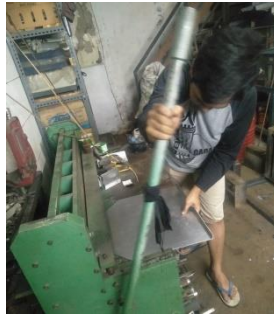
Gambar 4.52 Menekuk Plat Aluminium
