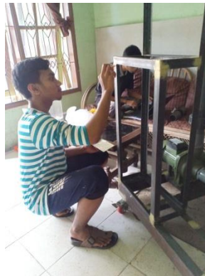
Gambar 4.16 Mendempul dudukan Panel
