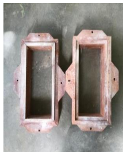
Gambar 4.39 Tempat Cetakan Bucket
