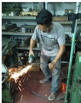
Gambar 4.21 Meratakan Permukaan Cincin Drum
