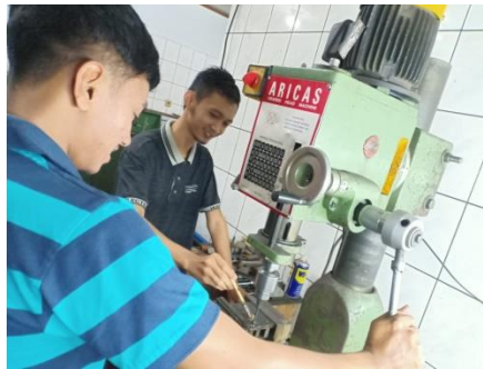
Gambar 4.20 Melubangi plat L untuk menyatukan kebase turbin
