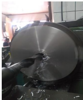
Gambar 4.35 Membuat lubang tengah pada runner
