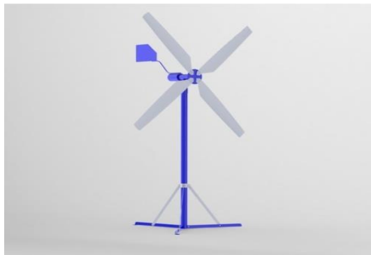
Gambar 4.1 Desain turbin angin sederhana tipe horizontal
