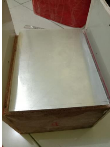
Gambar 3.3 Plat Alumunium Permukaan pemanas terbuat dari plat aluminium yang memiliki dimensi panjang 200 mm dan lebar 150 mm, dengan ketebalan 1mm. Plat alumunium terletak berada di atas pemanas listrik
