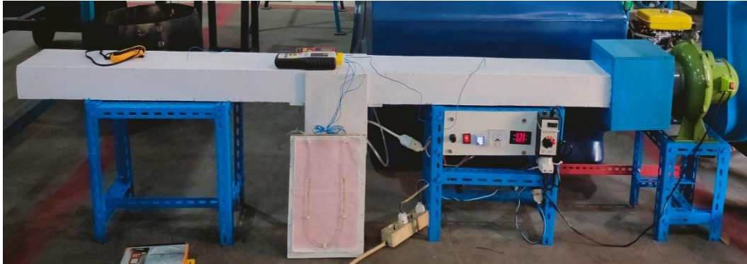
Gambar 3.1 Alat Uji Perpindahan Panas Pada Saluran Udara Segi Empat
